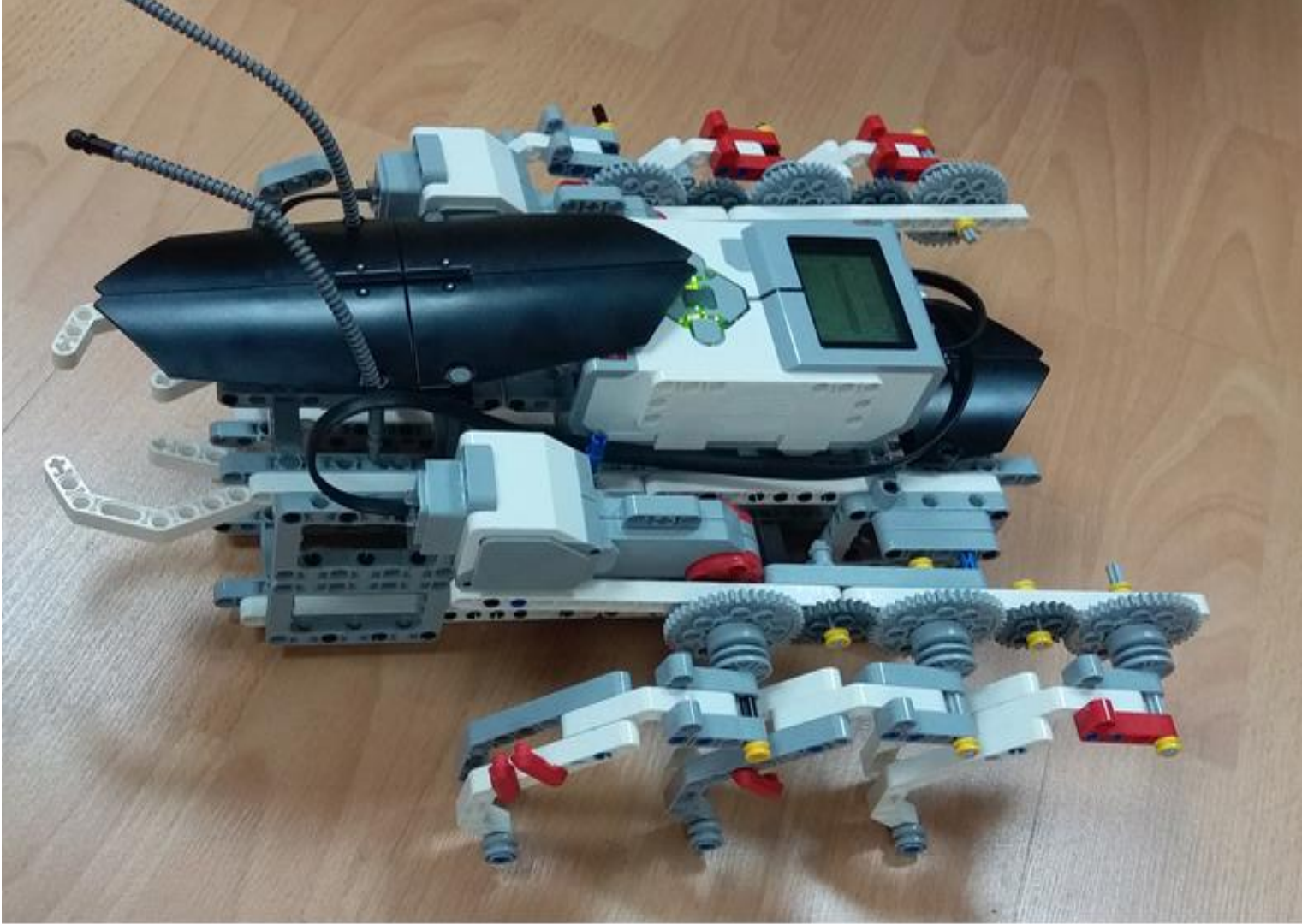
Şekil 3.5. Hamamböceği robot tasarımı – koşucu/yürüyücü bacak
