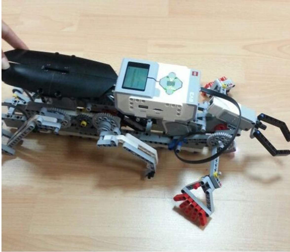
Şekil 3.7. Danaburnu robot tasarımı – kazıcı ayak
