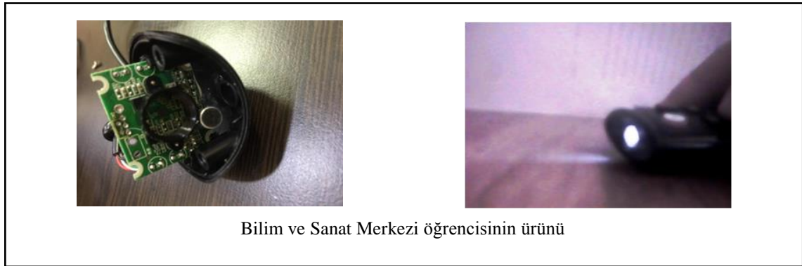
Şekil 4.29 Bilim ve Sanat Merkezi öğrencisi tarafından tasarlanan kızıl ötesi kameraya ilişkin görseller
