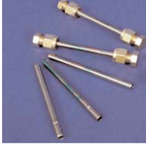
Şekil 5.12: Paslanmaz çelik sorbent tüplerin resimleri ve pirinç kapama başlıkları [6].
