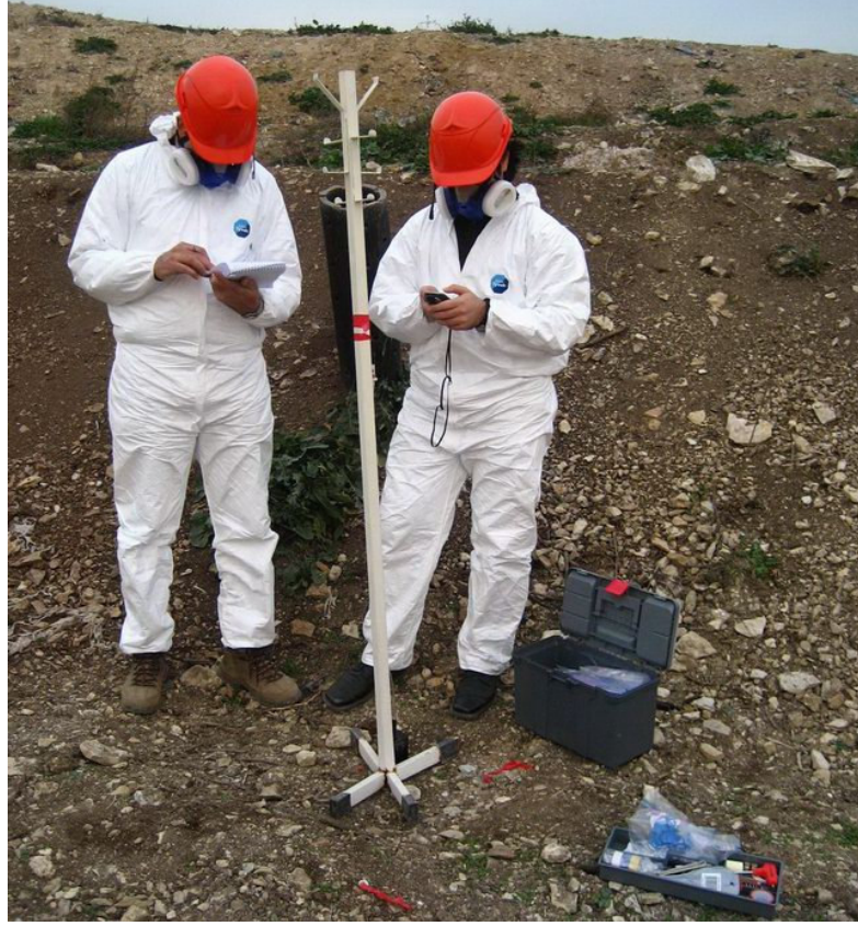
Şekil 5.15: Lot 5'te bir deponi gazı çıkış bacasında GPS koordinatlarının belirlenmesi.
