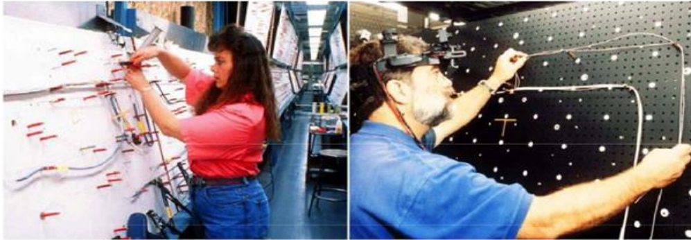
Şekil 2.5 Caudell ve Mizell'in “Boeing” havacılık firması için geliştirdikleri başa takılan görüntüleyici (Fee, 2018)
