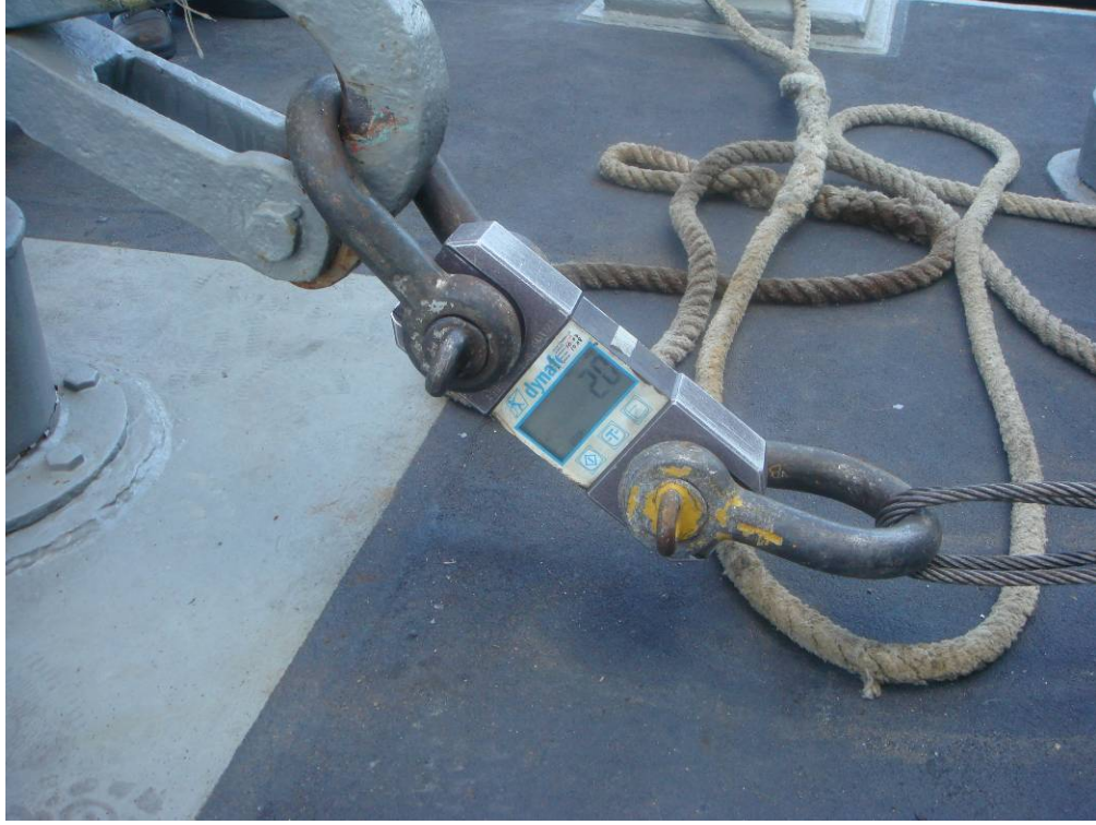
Şekil 5.40: Çekme kuvvetinin ölçüldüğü dinamometrenin görünüşü
