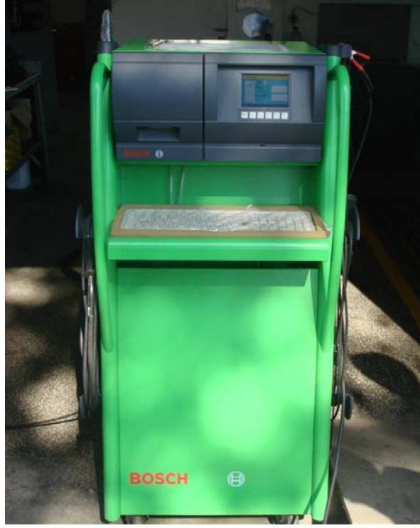
Şekil 5.46: Işık absorpsiyon katsayısının ölçüldüğü cihazın görünüşü
