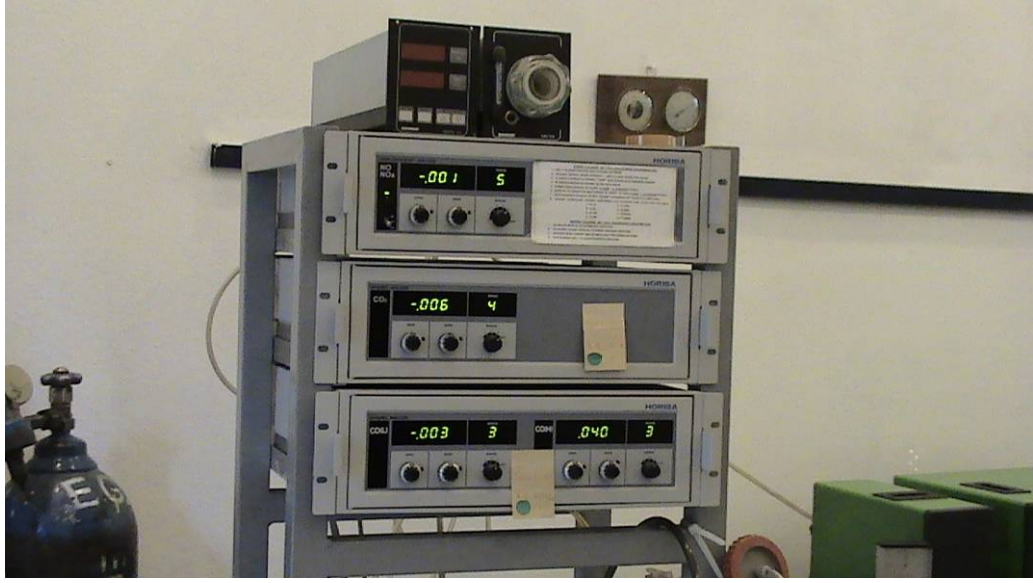
Şekil 4.10: HORİBA MEXA 574-GE egzoz emisyon cihazı (NO x , CO 2 , CO)
