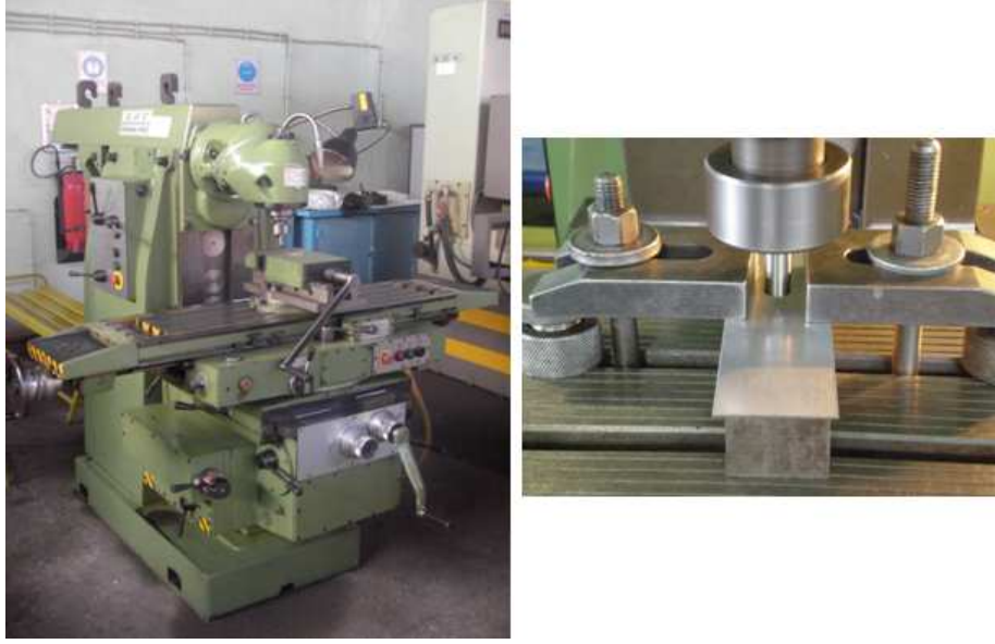
Şekil 6.7: Kaynak işleminde kullanılan freze tezgâhı ve kaynak edilecek parçaların freze tezgâhına bağlanması.
