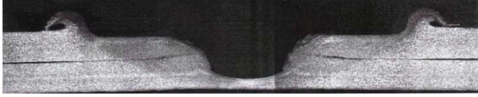
Şekil 4.24: 6111-T4 Alüminyum alaşımı numunede takım dalma derinliğine bağlı kaynak çevresindeki inceleme (Pan, 2007).
