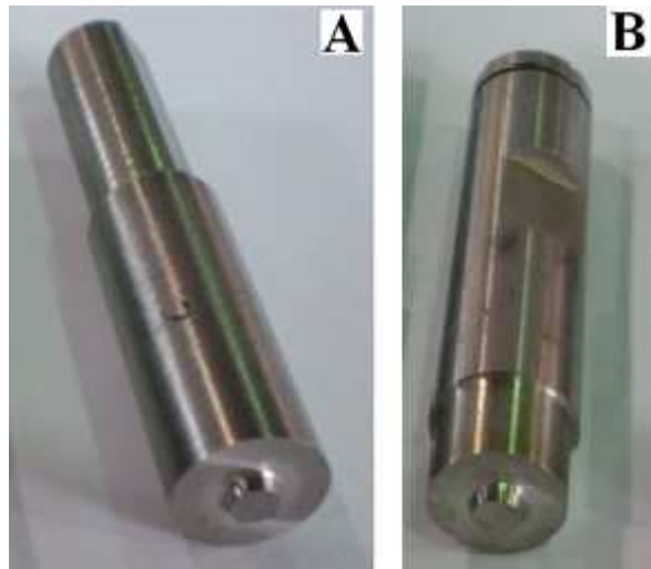
Şekil 6.11: Sürtünme karıştırma nokta kaynağında kullanılan takımlar A) Pim yüksekliği 1,4 mm, B) Pim yüksekliği 1,5 mm
