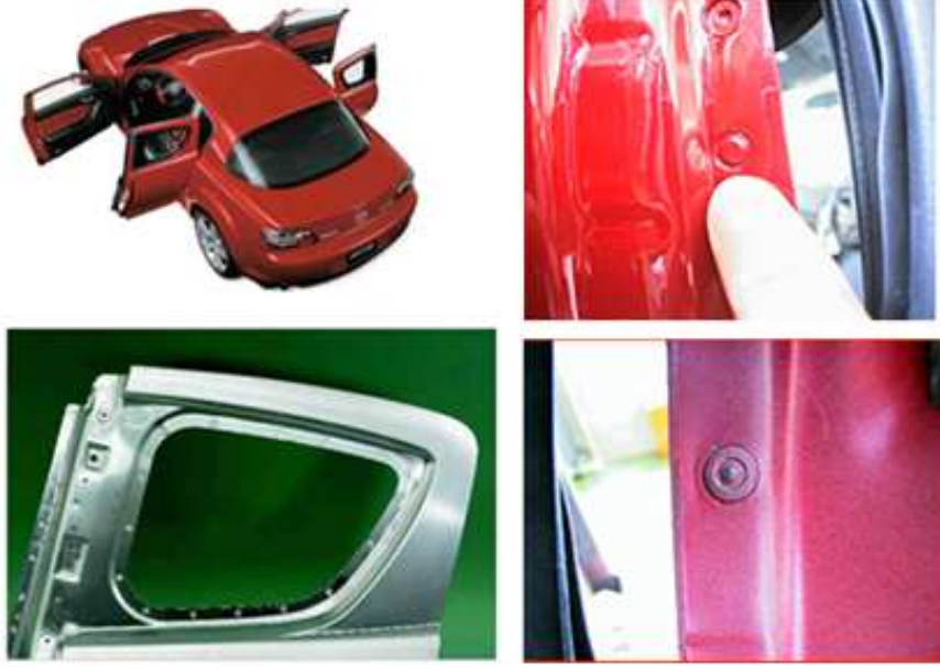
Şekil 1.1: Sürtünme karıştırma nokta kaynağı kullanılarak üretilmiş Mazda RX-8'in yan kapı paneli ve noktaların görünüşü (Kaluç ve Taban, 2007b).
