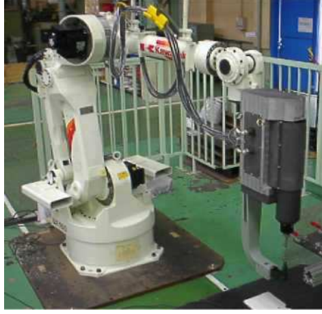
Şekil 4.20: Japonya’da geliştirilerek patenti alınan robotik FSSW makinası (Kaluç ve Taban, 2007b).
