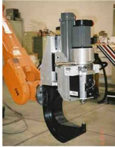
Şekil 4.19: Bir Amerikan kuruluşunca geliştirilen C- çerçeveli robotik sürtünme karıştırma nokta kaynak makinası (Kaluç ve Taban, 2007b).
