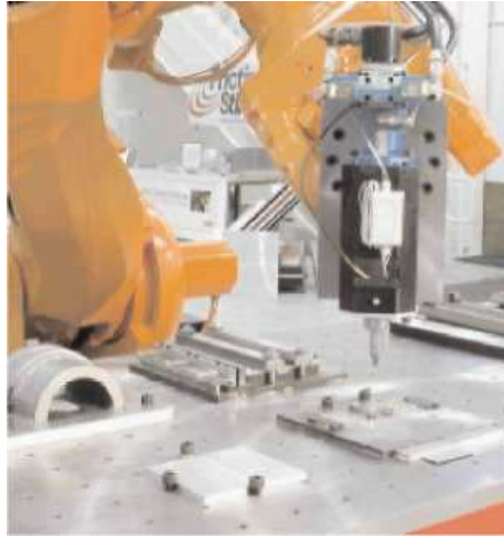
Şekil 4.21: Bir Amerikan kuruluşunca geliştirilen tezgah üstü kaynak işlemleri yapabilen robotik FSSW makinası (Kaluç ve Taban, 2007b).
