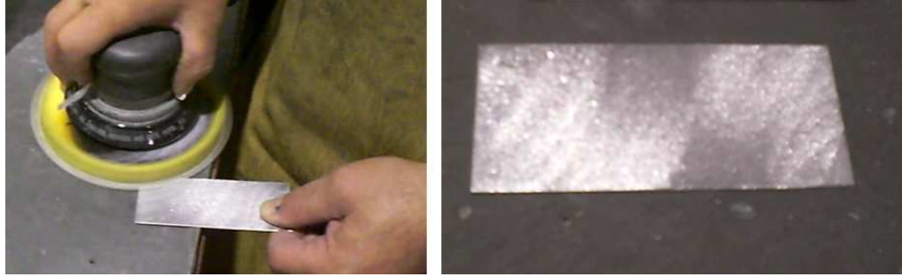
Şekil 6.2: Malzemenin zımparalanarak temizlenmesi
