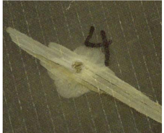
Şekil 6.8: Nano boyutta elmas toz katkısı bulunmayan plakaya ait 16 atış sonrası ön ve arka görüntüleri ile 1 numaralı atıştan 4 numaralı atışlar arası plaka görüntüleri.
