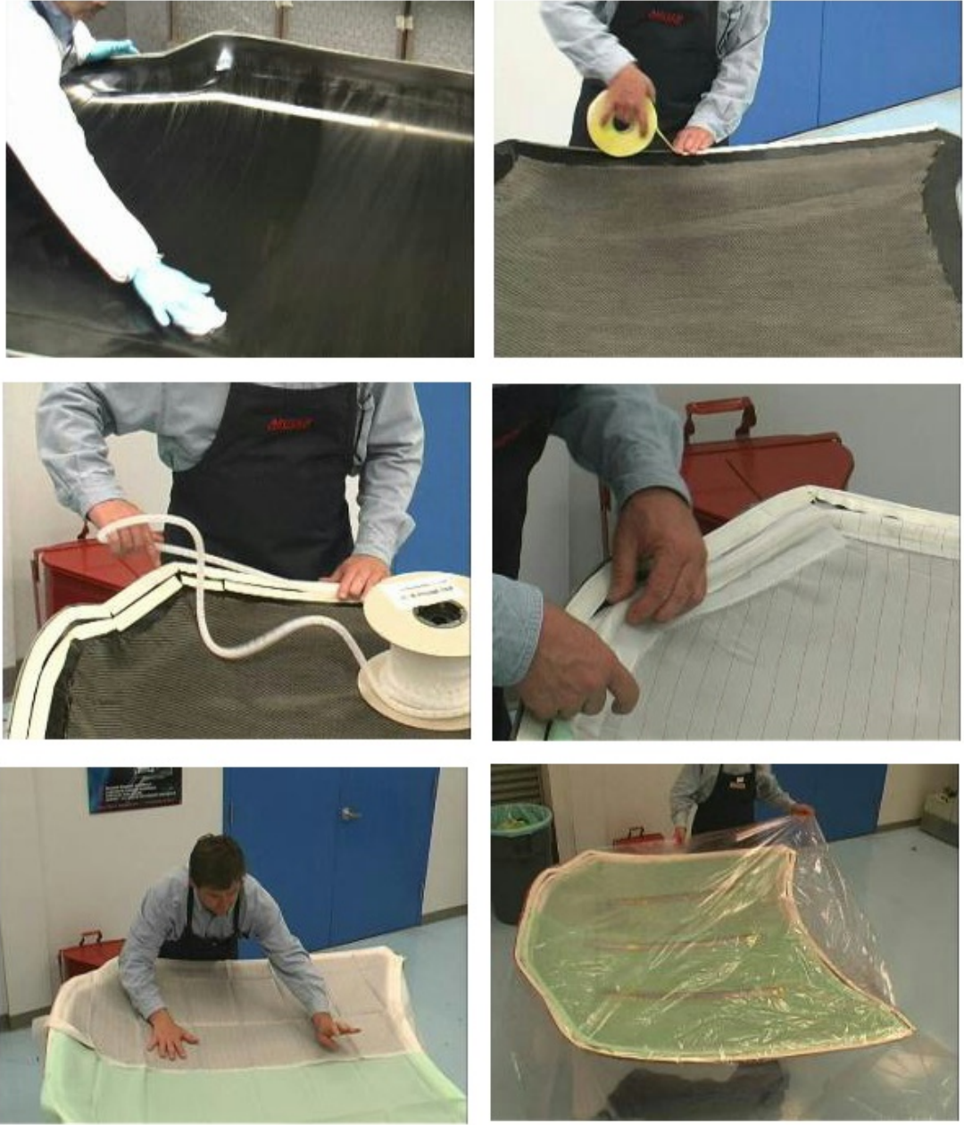
Şekil 6.5: Vakum infüzyon düzeneğinin hazırlanması (1) [43].
