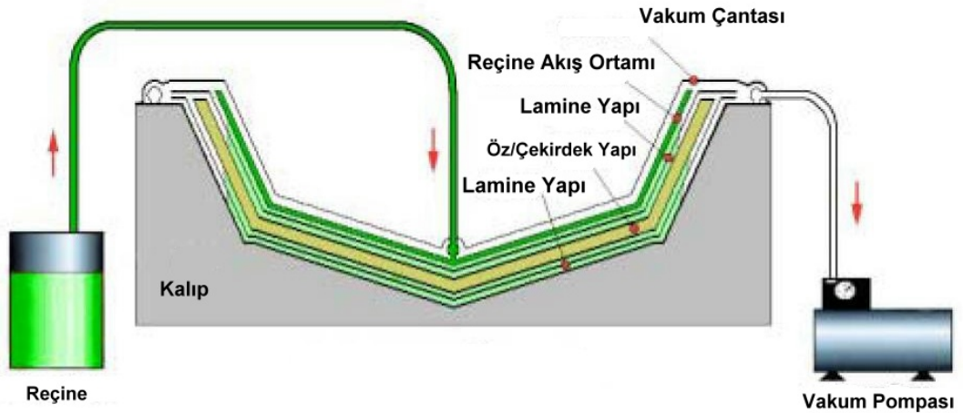
Şekil 4.2: Üretim adımları sonrası uygulamaya hazır bir parçanın enine kesiti (SCRIMP şeması) [27].
