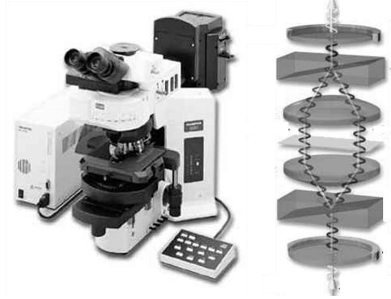
Şekil 3.16: Olympus interferans mikroskobu ve iki ışın yöntemini anlatır çizim [21].
