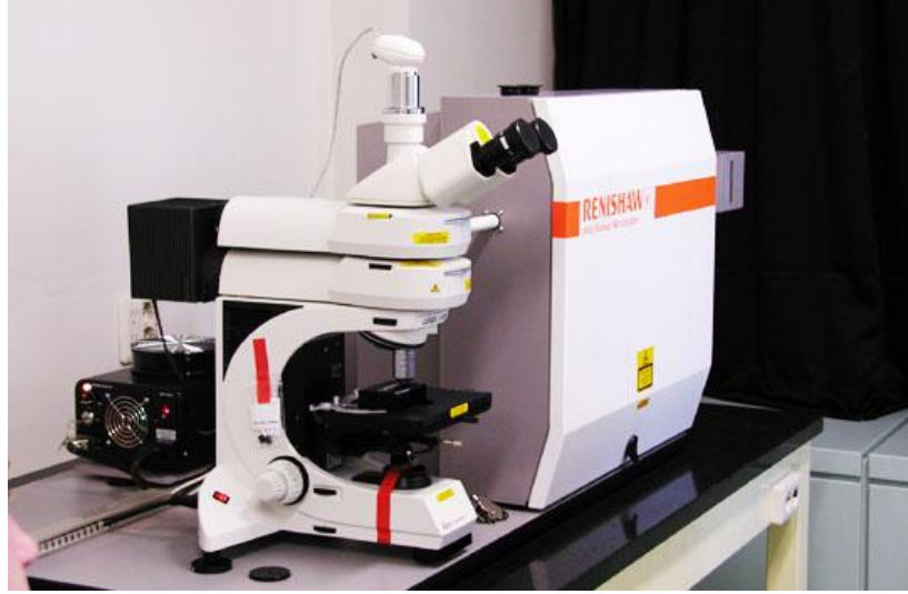
Şekil 2.4: Mikro-Raman Spektrometresi lazerin kullanıldığı hassas ölçüm alan bir cihazdır [8].
