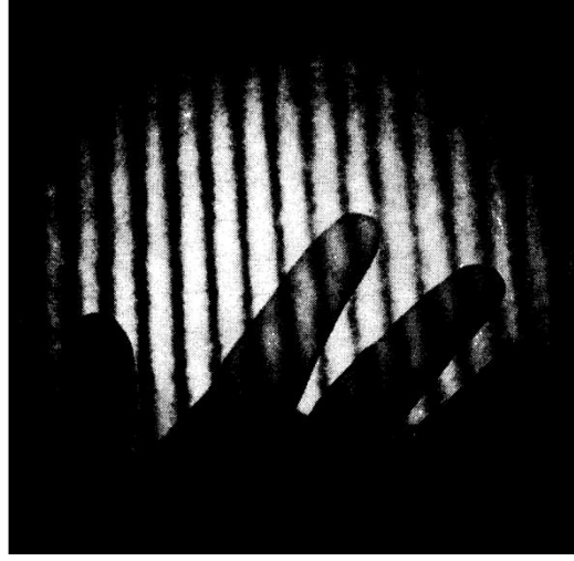
Şekil 2.3: Lazer kullanılarak oluşturulan Michelson girişimölçerinden bir saçak görüntüsü [6].
