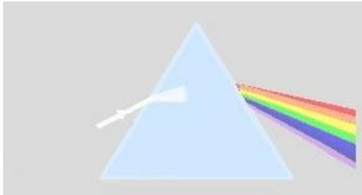
Şekil 2.5: Prizmadan geçirilen beyaz ışık dalga boylarına ayrılır ve görünür bölgede ki spektrumu verir [9].
