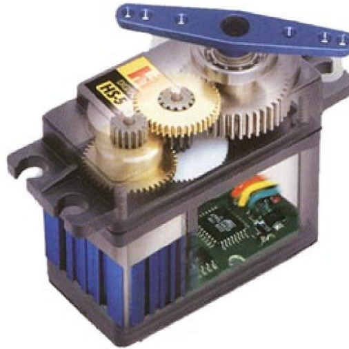
Şekil 2.15: Düşük güçlü bir DC servo motorun iç yapısı
