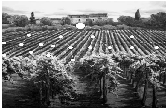
Şekil 2.8 : Hassas tarım için ad-hoc kablosuz algılayıcı düğüm dağılımı
