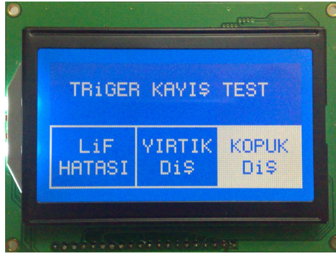
Şekil 7.16: Dış kopması hasarı uyarı görüntüsü
