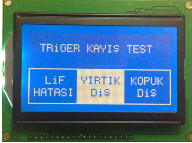
Şekil 7.15: Diş yırtılması hasarı uyarı görüntüsü
