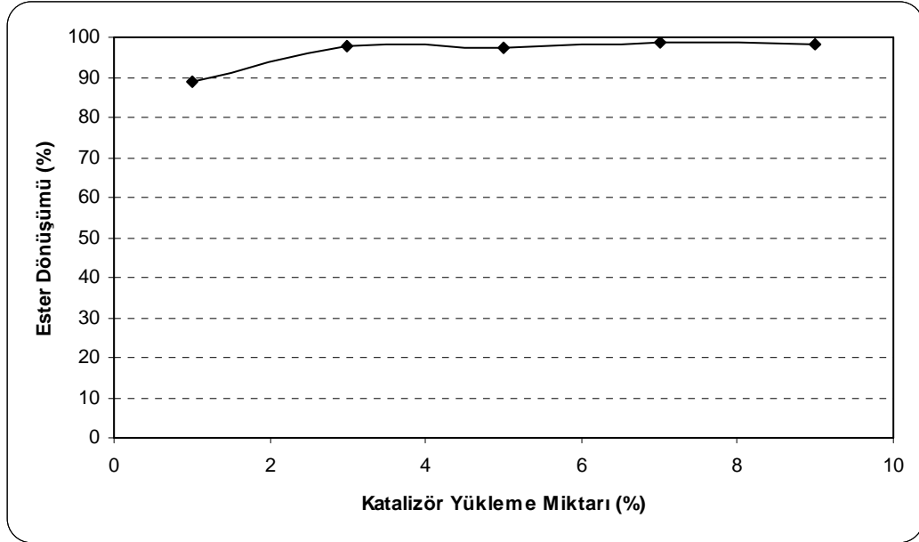
Şekil 5.8: Katalizör yükleme miktarının ester dönüşümüne etkisi (%25 K 2 CO 3 /ZnO, 6/1:metanol/yağ, 600rpm, 9 saat, 65°C)
