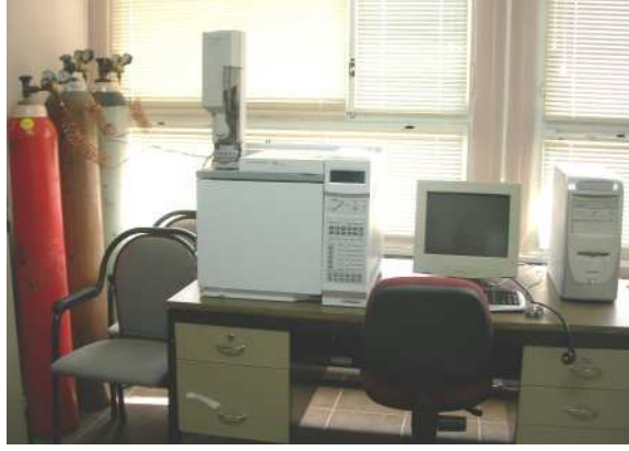
Şekil 4.7: GC analiz sistemi (biyodizelin ester içeriği ölçümü)
