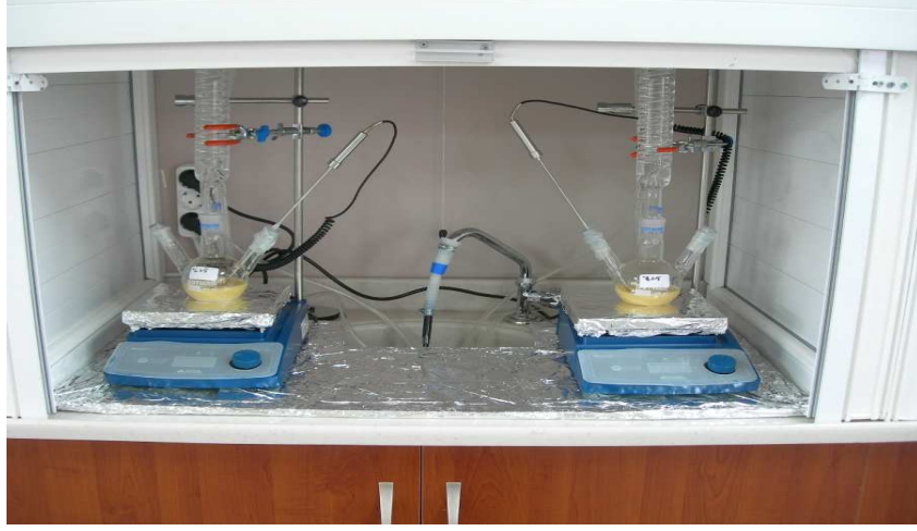
Şekil 4.4: Biyodizel üretim reaksiyonu (transesterifikasyon) sistemi
