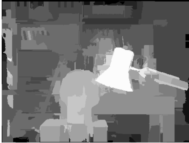
Şekil 4.15: Tsukuba stereo imgeleri için bölütleme temelli stereo eşleme ile elde edilen stereo uzaklık haritası (5-pencere ilinti yöntemi kullanılmıştır)
