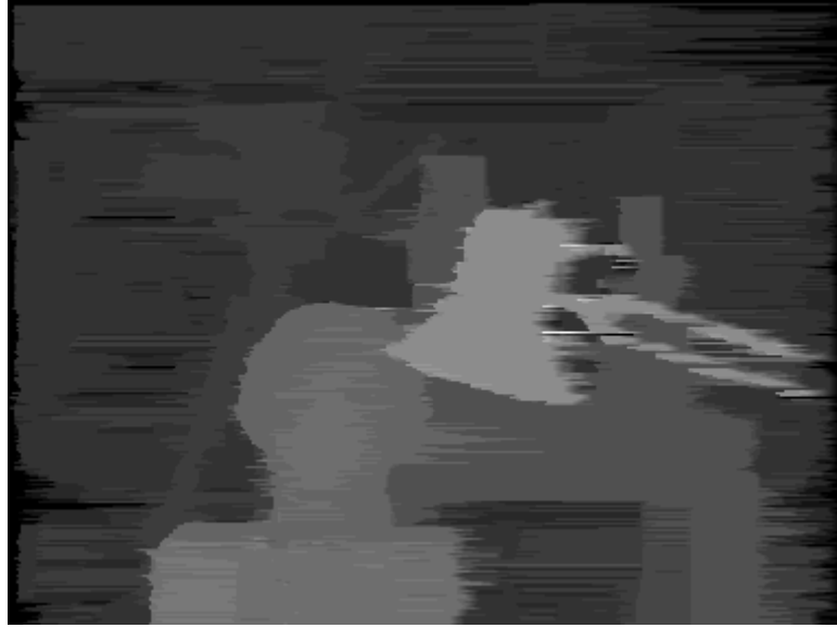
Şekil 4.14: Tsukuba stereo imgeleri için DP ile elde edilen sol stereo uzaklık haritası
