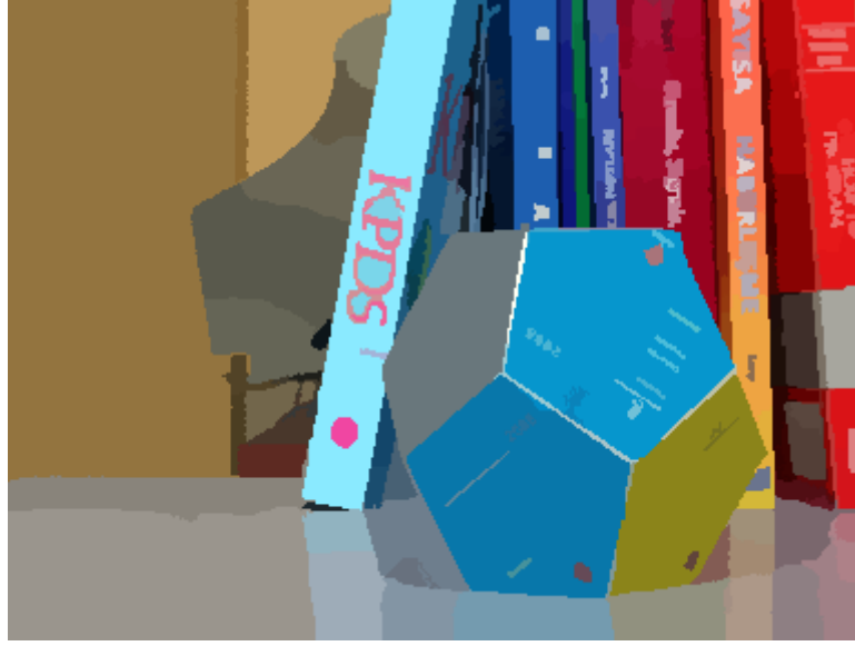
Şekil 4.20: küp imgesi için ortalama kaydırma yöntemiyle bölütlenmiş imge
