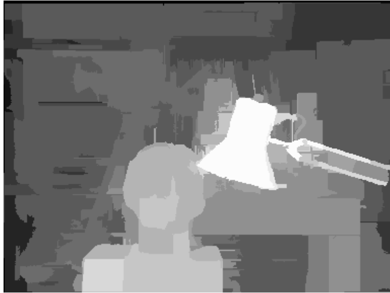
Şekil 4.17: Tsukuba stereo imgeleri için bölütleme temelli stere eşleme ile elde edilen stereo uzaklık haritası (dinamik programlama yöntemi kullanılmıştır)
