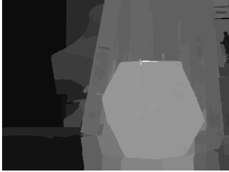
Şekil 4.18: Küp stereo imgeleri için bölütleme temelli stere eşleme ile elde edilen stereo uzaklık haritaları (dinamik programlama yöntemi kullanılmıştır)
