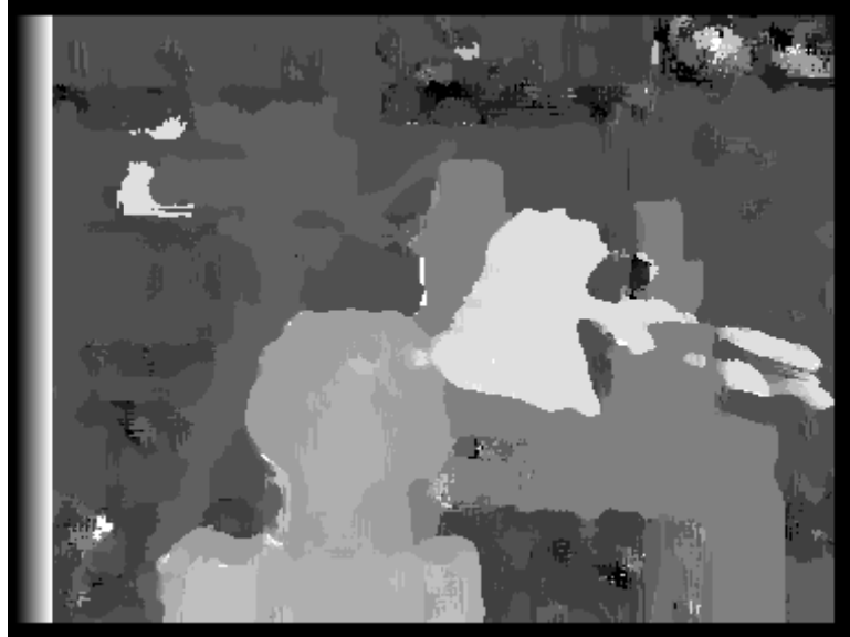
Şekil 4.4: 5-pencere düzenleşimi kullanılarak stereo eşleme yapılarak elde edilen stereo uzaklık haritası
