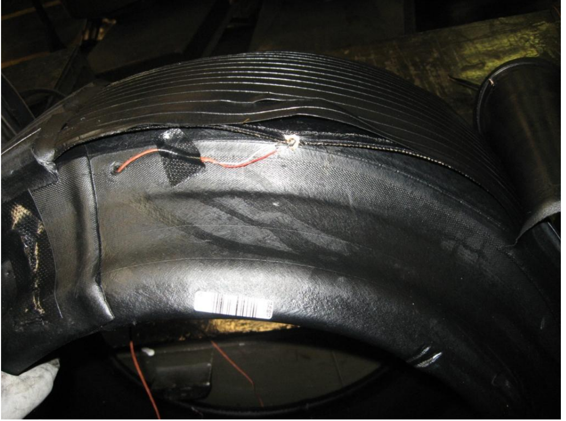
Şekil 6.23: 3.kontrol noktasına ısıçift yerleştirilmesi
