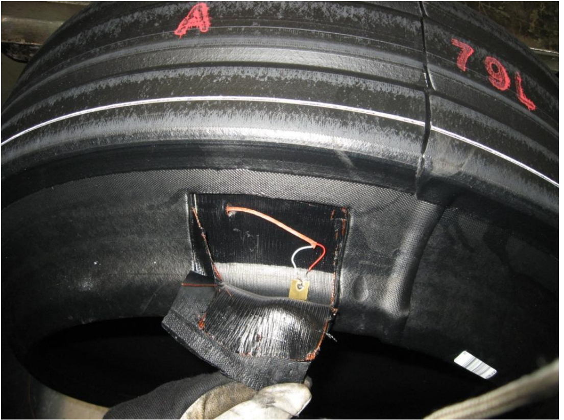
Şekil 6.22: 2.kontrol noktasına ısıçift yerleştirilmesi
