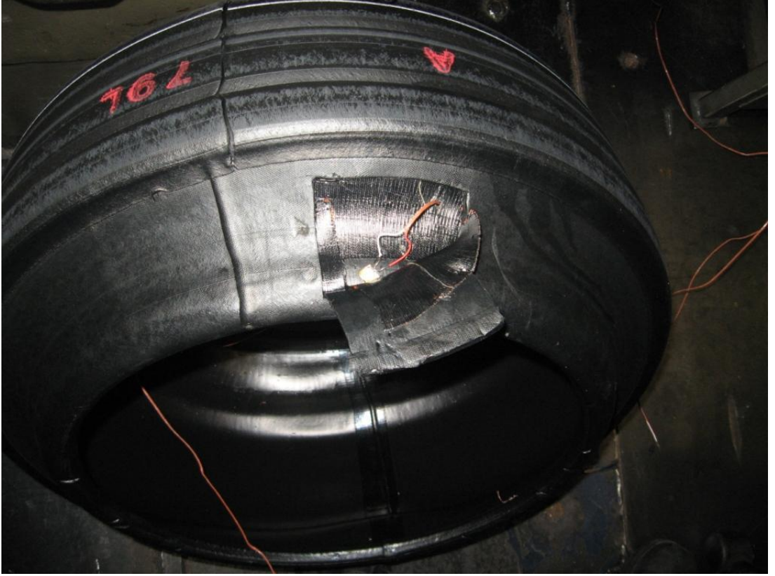
Şekil 6.21: 1.kontrol noktasına ısıçift yerleştirilmesi
