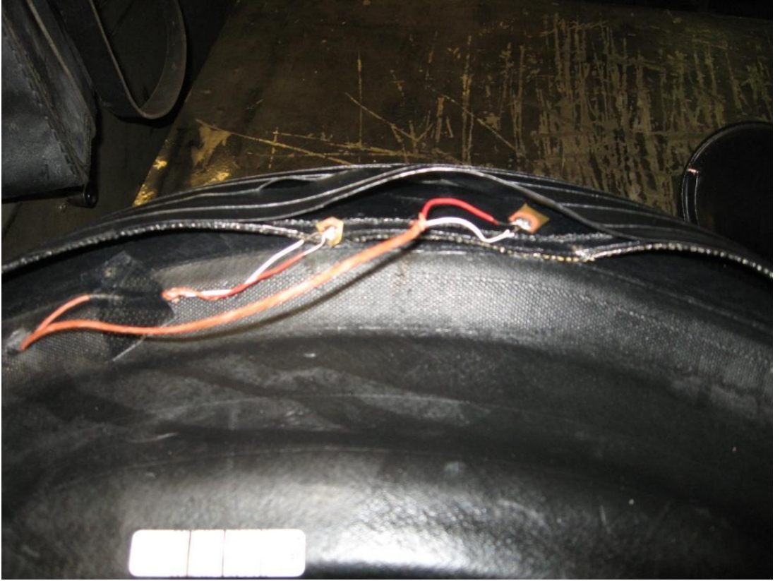
Şekil 6.24: 4.kontrol noktasına ısıçift yerleştirilmesi
