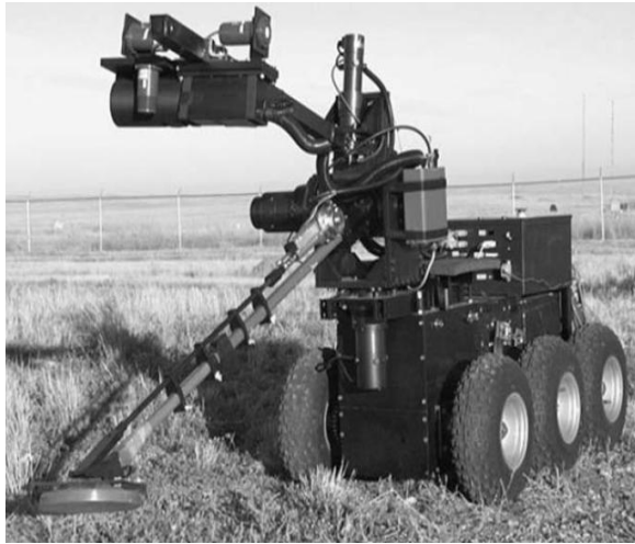
Şekil 1.1: Kara mayınları tespit amaçlı robot uygulaması [1]
