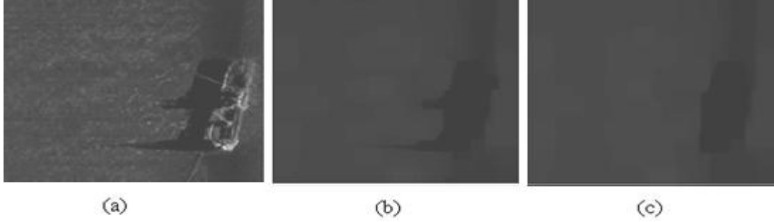
Şekil 4.23: (a) Ortanca Süzgeç Uygulanmış YTS imgesi, (b) 55-Komşuluklu Kare Tipindeki YE ile Açma İşlemi Uygulanarak Elde Edilen Gri İmge, (c) (b) İmgesine 55-Komşuluklu Kare Tipindeki YE ile Kapama İşlemi Uygulanarak Elde Edilen Gri İmge
