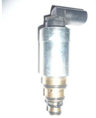
Şekil 3.10: Yalpalı plakalı değişken kapasiteli kompresörde kullanılan kontrol valfi
