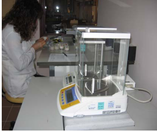
Şekil 3.18: Gravimetrik analiz için kullanılan tartım terazisi
