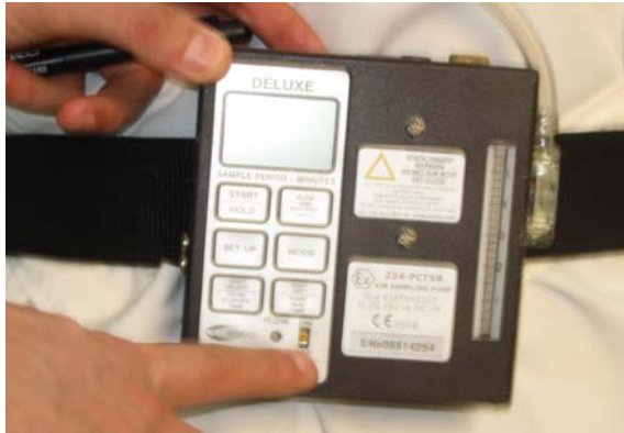
Şekil 3.15: İnsan solunum sistemine göre ayarlanmış numune alma pompası
