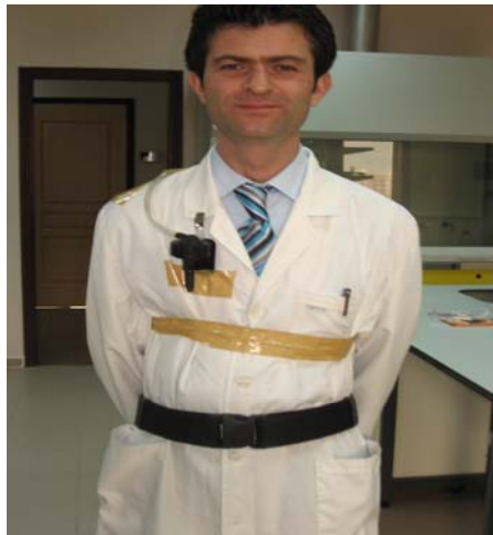
Şekil 3.17: Numune alma pompasının yerleştirilmesi
