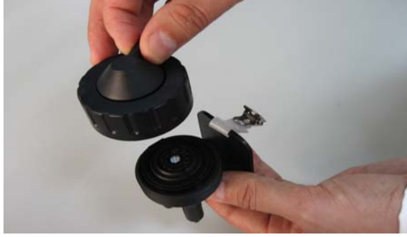
Şekil 3.13: PVC filtrenin muhafaza edildiği siklon başlık
