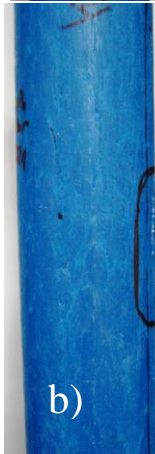
20 °C / Ø 75/ Hac. % 10 Premier Talk Katkılı YYPE / Kısa süre Hasar bölgesi a) Ön görünüş b) Yan görünüş
