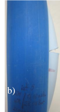
20 °C / Ø 63 / Hac. % 4 Kaplı CaCO 3 ve % 2 Talk Katkılı YYPE / Uzun süre Hasar bölgesi a) Ön görünüş b) Yan görünüş
