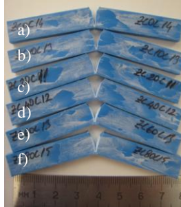
Hac.%20 İmercarb 2XG kalsiyum karbonat katkılı YYPE enjeksiyon numuneleri
