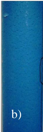
20 °C / Ø 75/ Hac. % 10 Talk 5XH Katkılı YYPE / Kısa süre Hasar bölgesi a) Ön görünüş b) Yan görünüş
