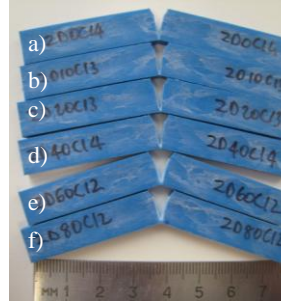
Hac.%20 İmercarb 5G kalsiyum karbonat katkılı YYPE enjeksiyon numuneleri
