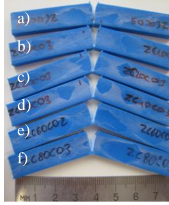
Hac.%10 İmercarb 2XG kalsiyum karbonat katkılı YYPE enjeksiyon numuneleri
