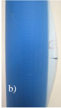
20 °C / Ø 63 / Hac. % 10 Kaplı CaCO 3 Katkılı YYPE / Uzun süre Hasar bölgesi a) Ön görünüş b) Yan görünüş
