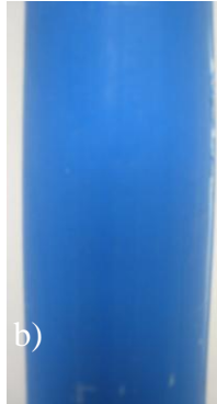
20 °C / Ø 63 / Hac. % 6,7 Kaplı CaCO 3 ve % 3,3 Talk Katkılı YYPE / Uzun süre Hasar bölgesi a) Ön görünüş b) Yan görünüş
