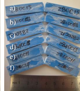
Hac.%20 İmercarb 1G kalsiyum karbonat katkılı YYPE enjeksiyon numuneleri
