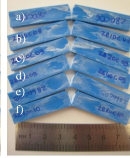
Hac.%15 İmercarb 1G kalsiyum karbonat katkılı YYPE enjeksiyon numuneleri
