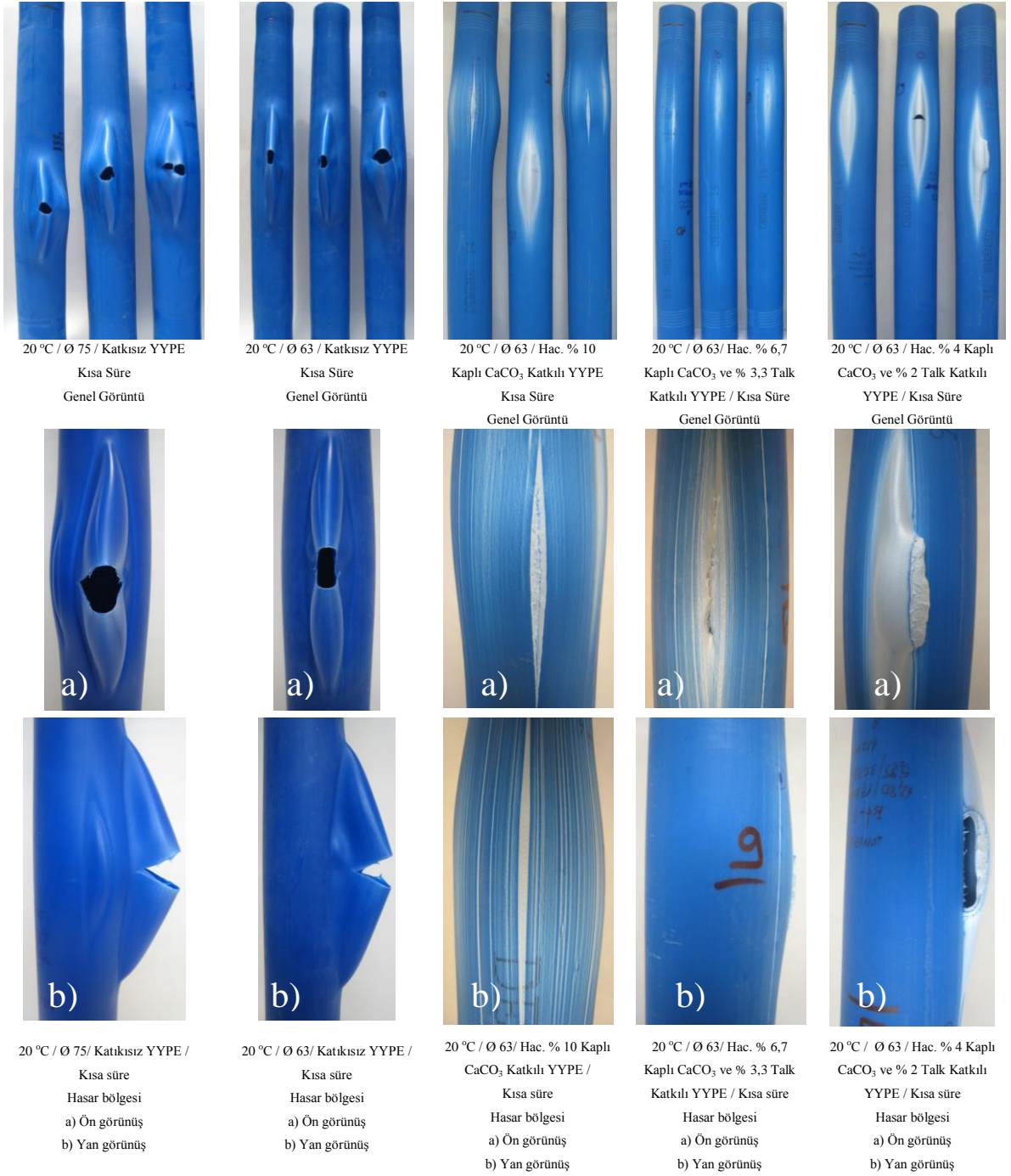
Şekil A6: 20 °C de farklı çaplarda katkısız YYPE ve farklı hacim oranlarında ve farklı türlerde mineral katkı yüksek yoğunluklu polietilen boruların kısa süreli hidrostatik iç basınç testi sonrası hasar bölgeleri
