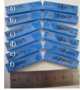
Hac.%10 İmercarb 1G kalsiyum karbonat katkılı YYPE enjeksiyon numuneleri
