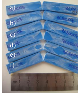
Hac.%15 İmercarb 2XG kalsiyum karbonat katkılı YYPE enjeksiyon numuneleri
