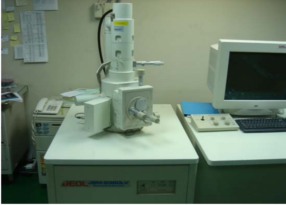
Şekil 3.32: Taramalı elektron mikroskobu
