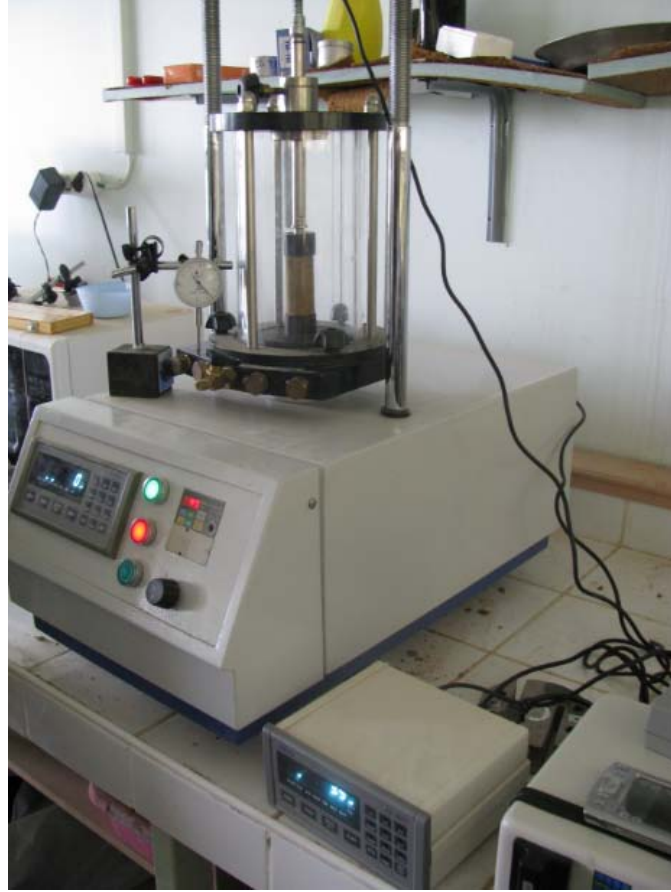
Şekil 3.8: Serbest basınç düzeneği
