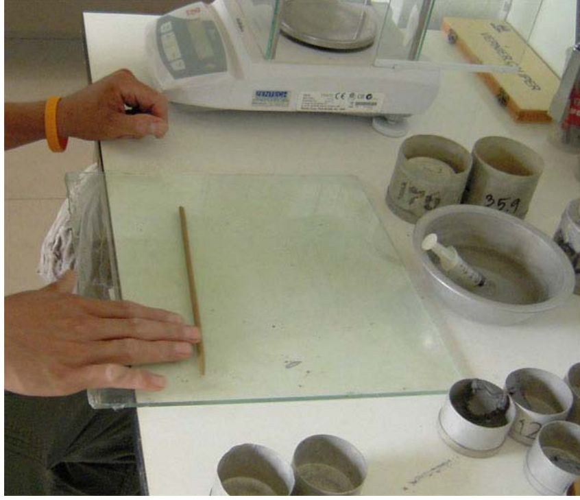
Şekil 3.3: Plastik limit numune hazırlanmasına bir örnek
