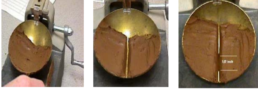
Şekil 3.2: Likit limit deneyi
