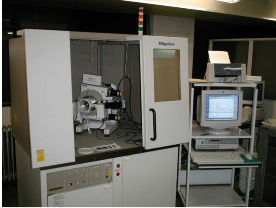
Şekil 3.39: Rigaku Rint2200 X.R.D deney düzeneği
