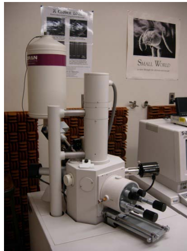
Şekil 3.29: Thermo Noran System Six enerji dağılım spektrometresi
