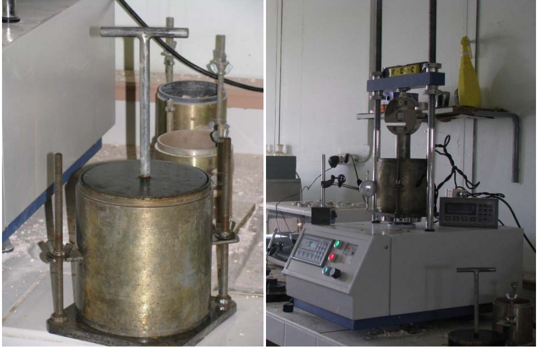
Şekil 3.26: CBR düzeneği ve test işlemi
