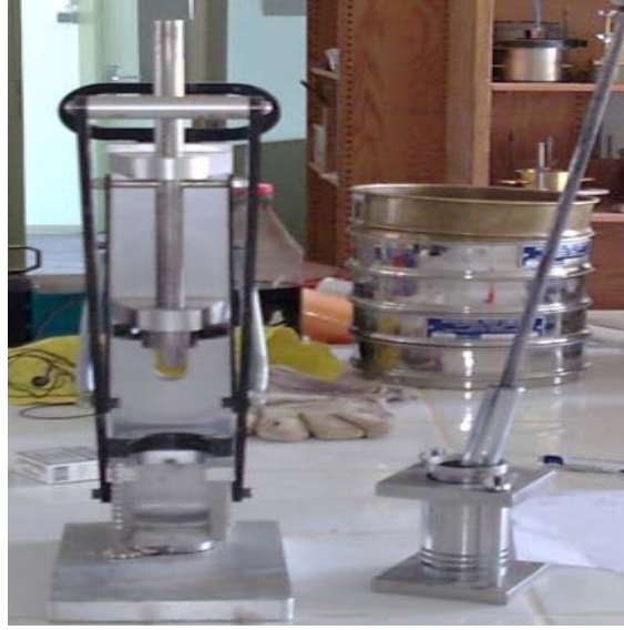
Şekil 3.7: Minyatür Proctor düzeneği
