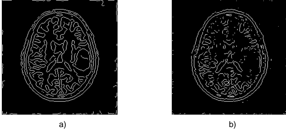
Şekil 2. 17: Canny ve LoG kenar bulma yöntemlerinin karşılaştırılması. a) Canny kenar bulma yöntemi sonucu. b) LoG kenar bulma yöntemi sonucu.
