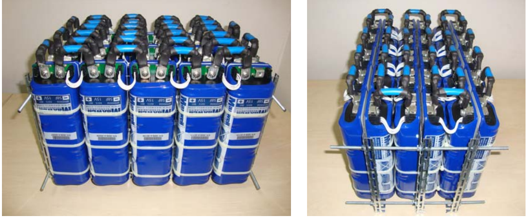
Şekil 5.25: Paketlenmiş 450V 1,93F kapasiteli ultra-kapasitör bankasının a) ön ve b) yan görüşleri
