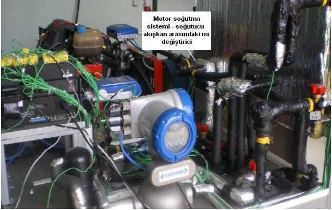
Şekil 3.7: Motor soğutma suyu sistemi ve soğutucu akışkan arasındaki ısı değişiricinin fotoğrafı
