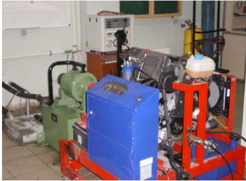
Şekil 3.24: Deneylerde kullanılan dizel motoru ve hidrolik dinamometrenin genel görünümü
