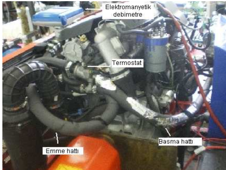
Őekil 3.15: Motor sođutma suyu kalorifer peteđi hortum su taŐıma bađlantıları
