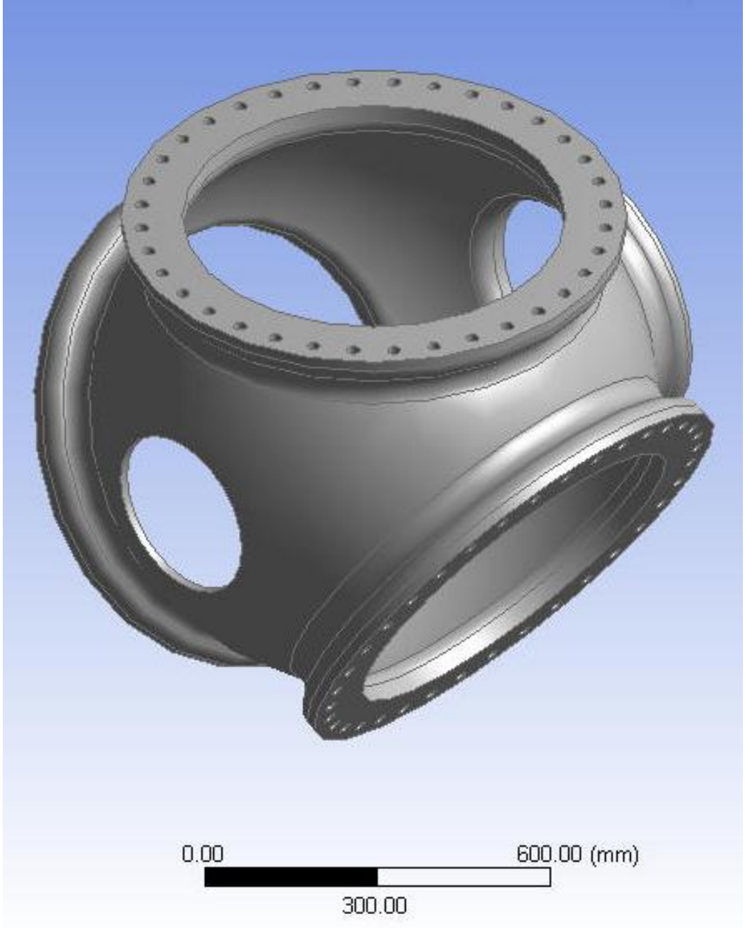
Şekil 8.2 : Halka Kalınlık Çarpanı 3'ten 5'e çıkarıldığında göbek geometrisi yeni durumu.
