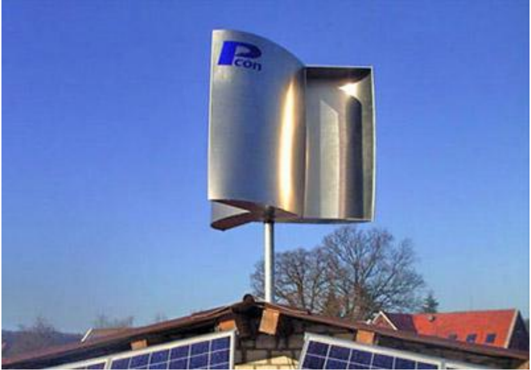
Şekil 3.5: Savonius tipi rüzgar türbini [24]
