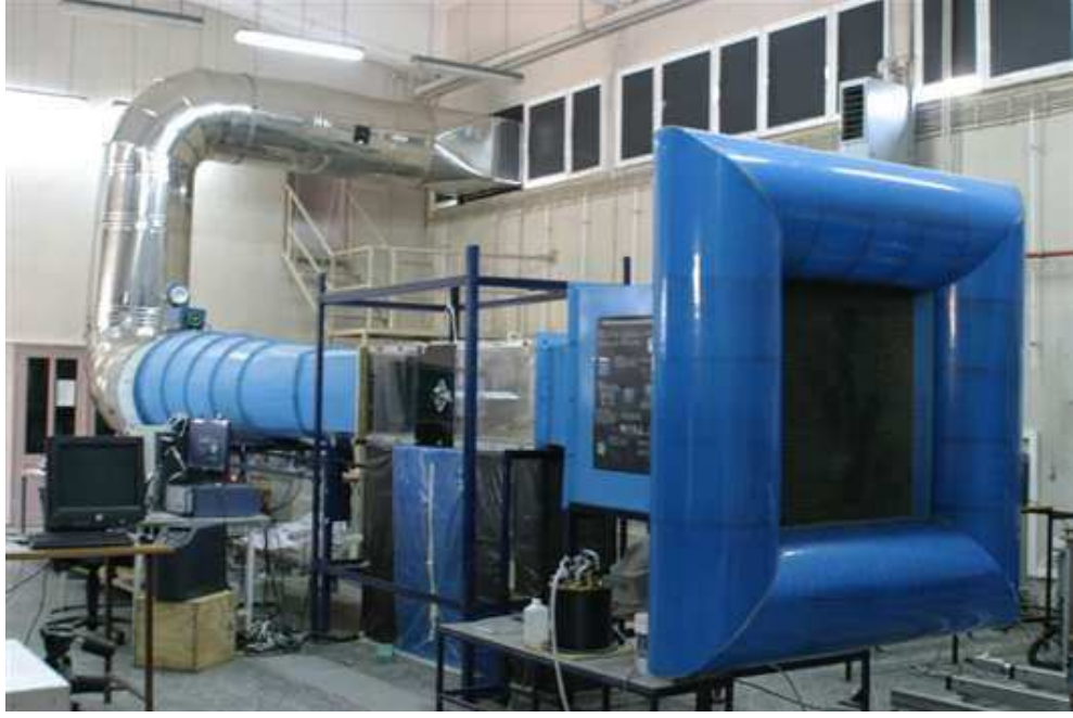
Şekil 6.1: İ.T.Ü. açık çevrimli emişli tip rüzgar tüneli
