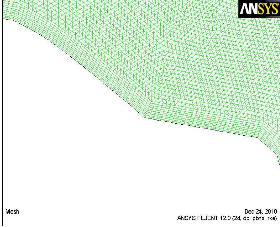
Şekil 6.41: Sedan tipi otomobilin mesh yapısı
