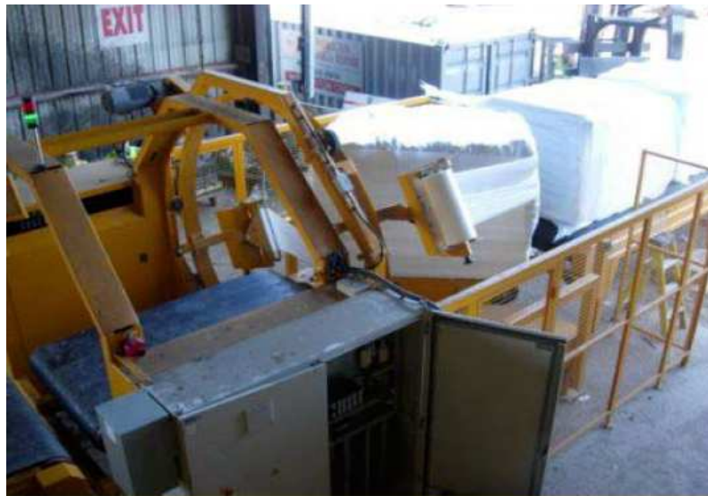
Şekil 3.2: Dikdörtgen balyaların sarma işlemi
