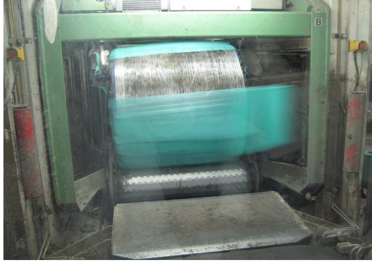
Şekil 4.12: Kentsel katı atıkların balyalama makinasında sarılması
