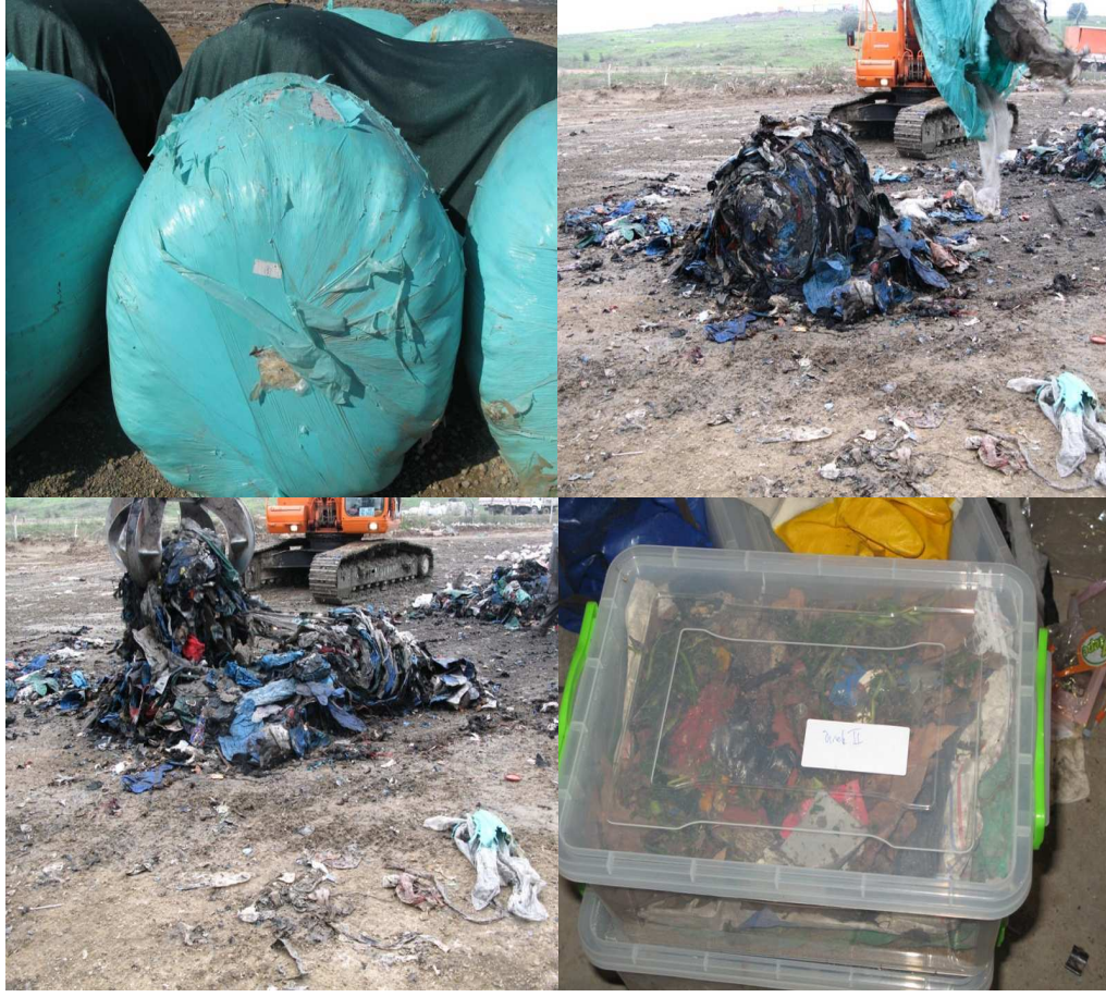
Şekil 4.20: Depolama sonrası balyaların açılması ve örnekleme
