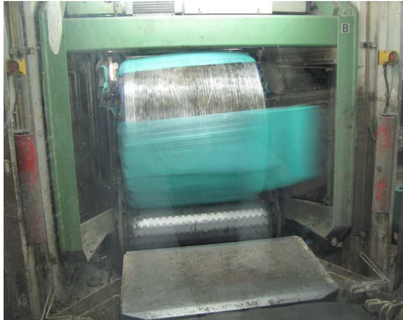
Şekil 3.3: Balyaların LDPE malzeme ile sarılması
