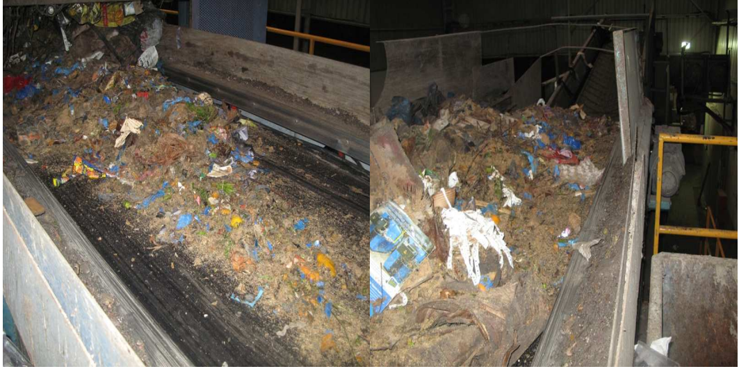
Şekil.4.18: Atık karışımının balyalama makinesine beslenmesi
