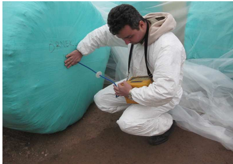
Şekil 4.13: Balyalarda gaz ölçümlerinin gerçekleştirilmesi
