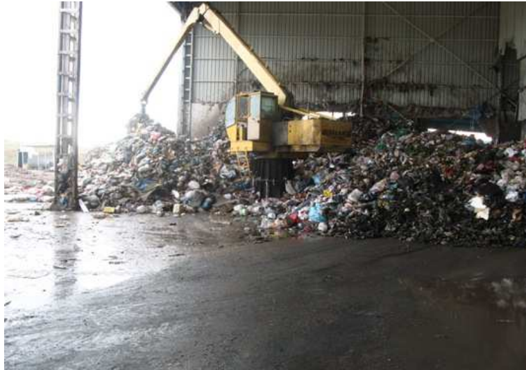
Şekil 4.7: Atıkların banta beslenmesi
