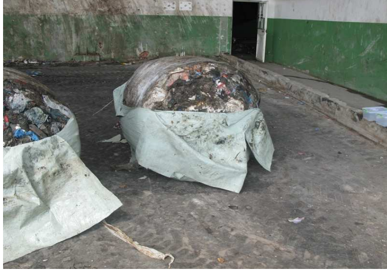
Şekil 4.14: Kentsel katı atık balyalarının açılması
