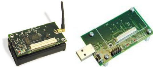
Şekil 4.1: MicaZ algılayıcı düğüm ve MIB520 programlama bordu (erişim noktası)
