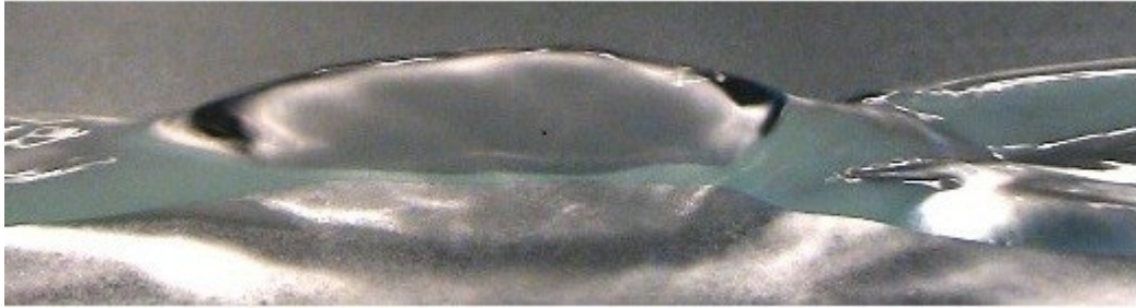
Şekil 4.11: Islanmaz yüzeye çarptıktan sonra yayılarak tekrar birleşen akışkanın birleşme noktasındaki görüntüsü (Kibar, 2008).
