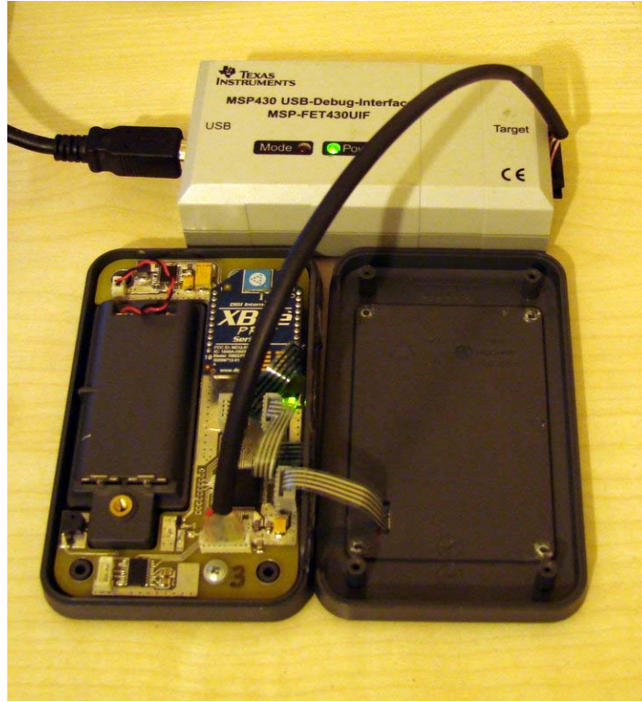
Şekil 2.20: MSP-FET430UIF Debugger ve GALİLE'ye Bağlantısı
