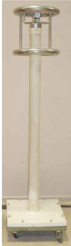
Şekil 6.13: Yapımı gerçekleştirilen 100 kV ohmik gerilim bölücü.
