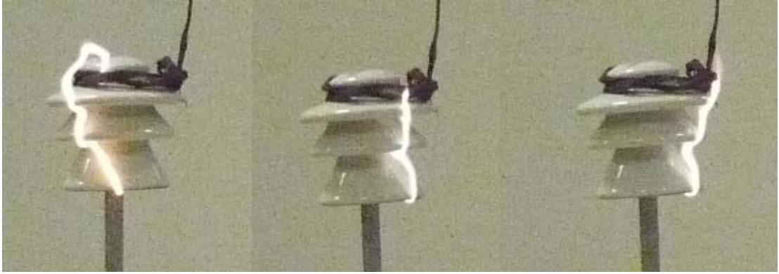
Şekil 2.2: Mesnet izolatöründe meydana gelen atlama (KOU Y.G. Lab.).
