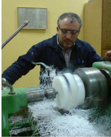
Şekil A.4: Yapay kusur için pleksiglas numunelerin tornada işlenmesi
