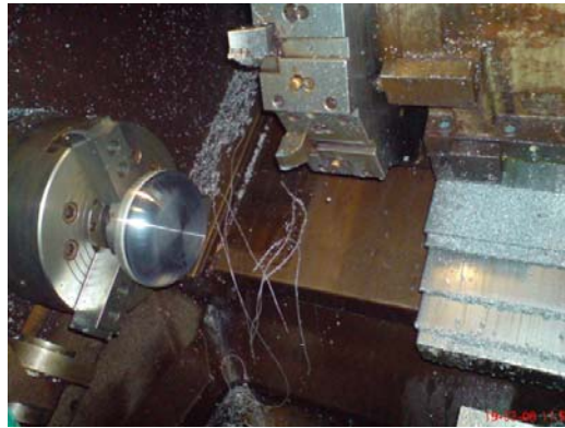
Şekil A.5: Rogowski profiline sahip disk elektrotların CNC tornada yapımı
