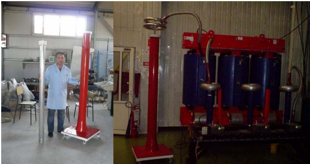
Şekil 6.3: Kuplaj kondansatörünün gerçek boyutları.
