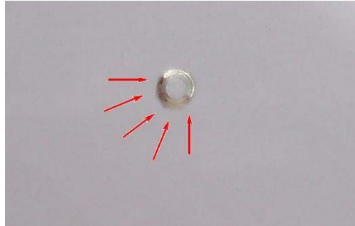
Şekil 8.1: Kısmi boşalma darbelerinin yalıtkanında meydana getirdiği yaşlanma.
