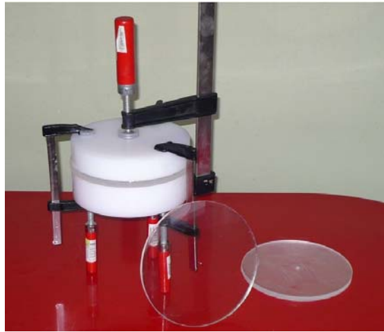
Şekil 6.31: Yapay boşluk içeren deney numunelerinin yapımı.
