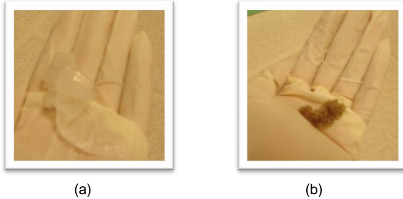
Şekil 5.20: Düşük viskoziteli PDMS, HMS ve Ptk ile hazırlanan membran denemeleri: Katkısız membran (a), ZSM-5 katkılı membran (b)
