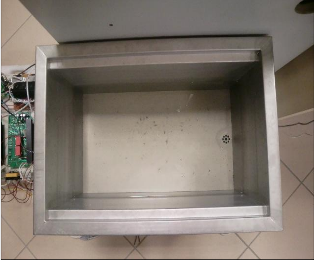
A4: Farz farklı alıřmalar iin yaptırılmıř 12 transducer elemanlı temizlik tankının fotoėrafı
