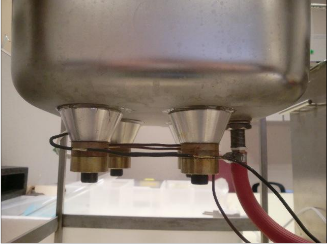
A5: Ultrasonik transducer'ların temizlik kazanı altına monte edilmiş hali
