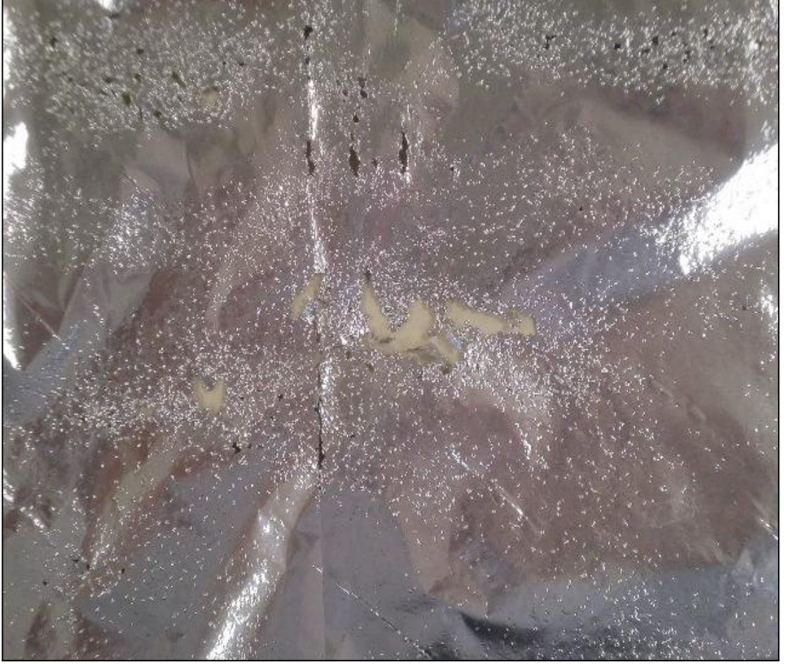
Şekil 7.2: Folyo testi sonucu elde edilen ve homojen olmayan bir temizleme profilinin görüntüsü
