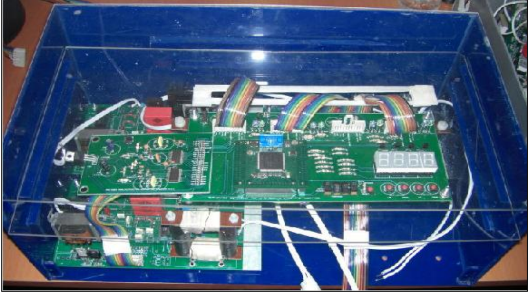
řekil 3.2: Jeneratör prototipinin yapısı, gü ve kontrol devreleri(2)
