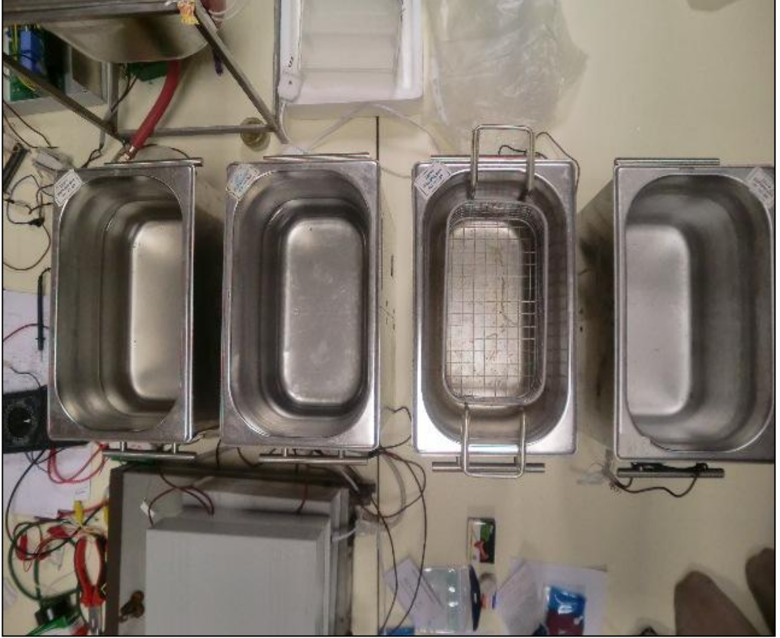
A3: 38-48 KHz arası her biri deęişik rezonans frekanslarında alıřan 4 adet temizlik tankı
