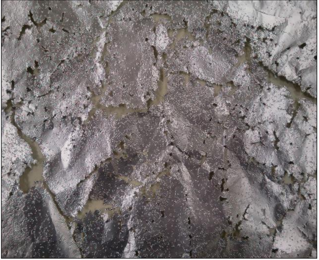
Şekil 7.3: Folyo testi sonucu elde edilen ve nispeten homojen sayılabilecek bir temizleme profilinin görüntüsü
