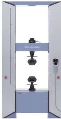
Şekil 3.6: Shimadzu AG-X çekme test cihazı
