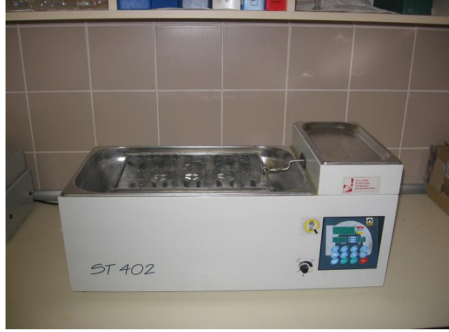
Şekil 4.7: Adsorpsiyon deneylerinde kullanılan su banyolu sallayıcı
