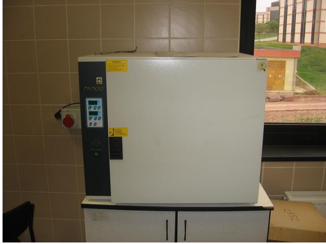
Şekil 4.10: Adsorbent sentezinde kullanılan etüv
