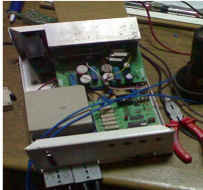
Şekil 4.60: Tezde kullanılan deneysel DA-DA dönüştürücü görünümü
