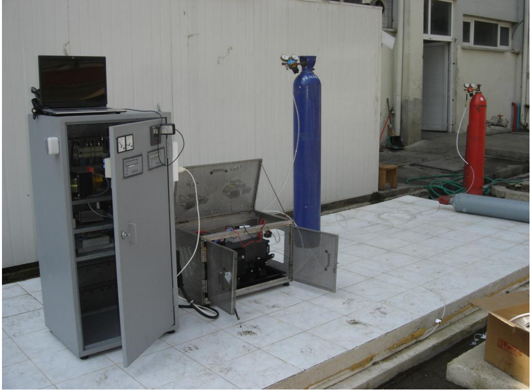
Şekil 4. 2: Li-iyon pil destekli yakıt pili sisteminin fotoğrafı
