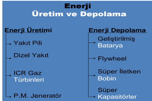
Şekil 3. 1: Gemiler için enerji elde etme yöntemleri prensibi
