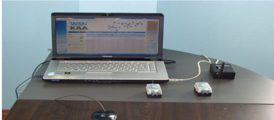
Şekil 5.2 : Web tabanlı ortam gözleme uygulaması için kurulan sistem
