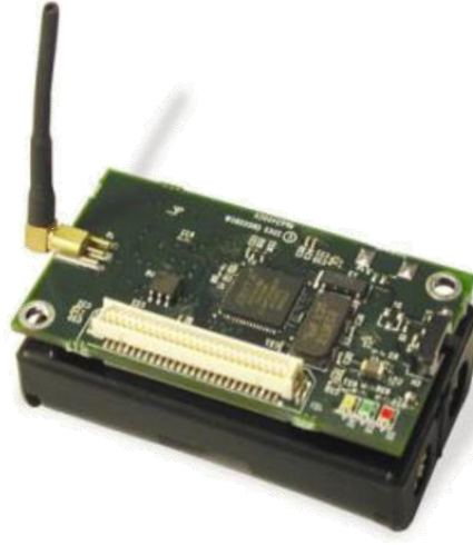
Şekil 4.5 : MicaZ algılayıcı düğümü [6]
