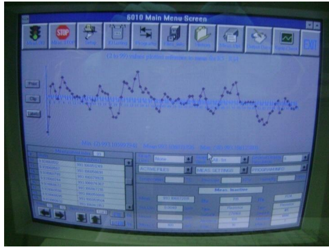
Şekil 7.7: Otomatik direnç ölçüm köprüsünde ölçülen direnç değeri verileri
