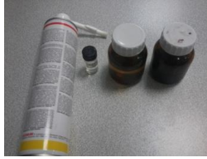
Şekil 7.2: Kimyasal işlemlerde kullanılan yağ temizleyici sprej, aggressive flux, kromik asit ve sülfirik asit
