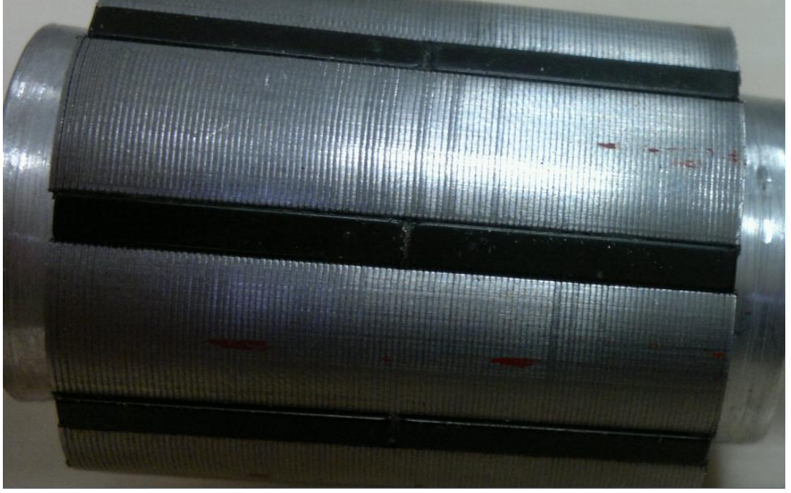
Şekil 3.16. Mıknatısların rotor segmentlerine yerleştirilmiş hali
