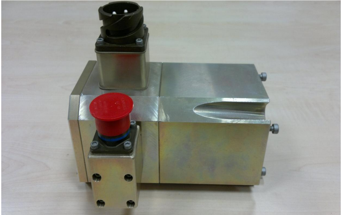
Şekil 3.21. Yüzeinden mıknatıslı AC servo motor gövdesi yan görünüş
