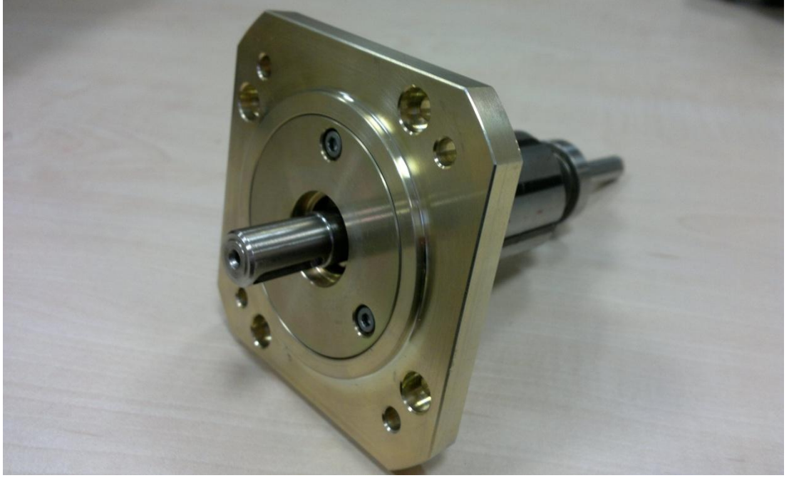
Şekil 3.18. Yüzeinden mıknatıslı AC servo motor rotoru ön görünümü
