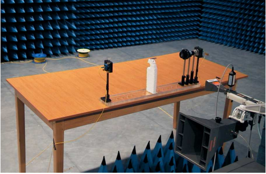
Şekil 2.7. Yansımaz oda içerisindeki taşınmaz yapıdaki ölçüm düzeneği
