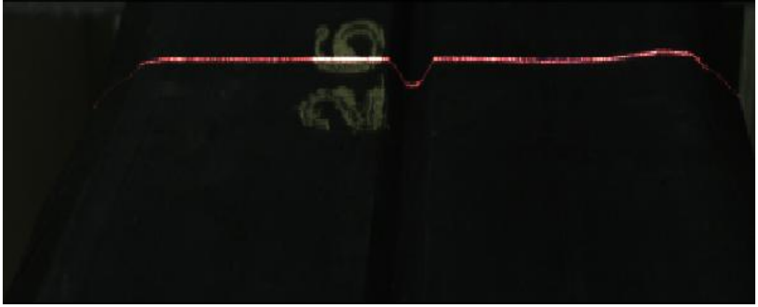
Şekil 2.4. Çizgi lazerin lastik sırtına iz düşürülmesiyle elde edilen örnek görüntü
