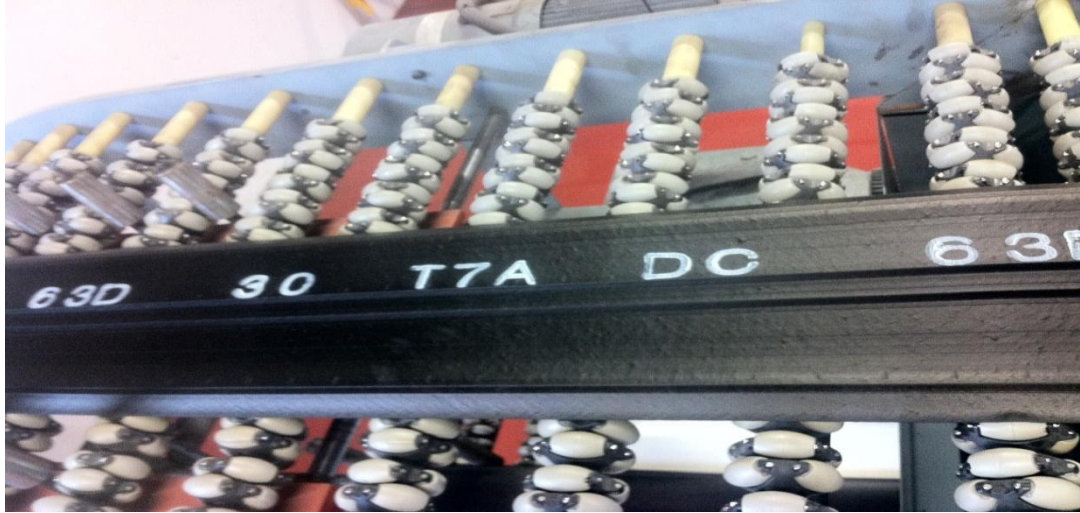
Şekil 1.4. Üretim bandında akan örnek bir lastik sırtı
