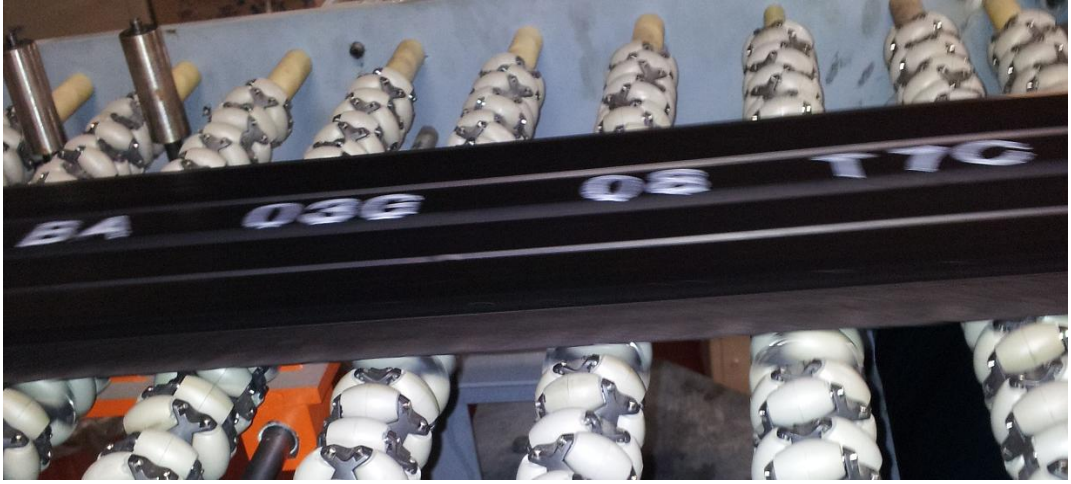
Şekil 1.6. Örnek bir lastik sırtının üretimi sırasında alınan görüntü
