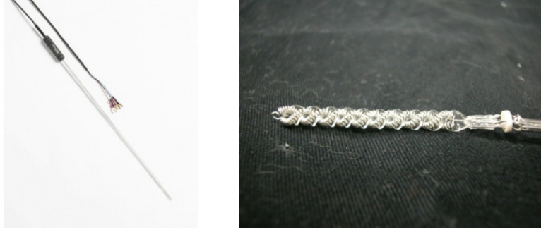
Şekil 4.10. Standart platin direnç termometre [57] ve sensör görünümü
