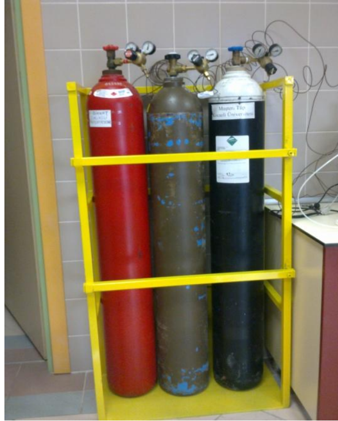
Şekil 2.14. Taşıyıcı gazlar ve kuru hava içeren tüpler
