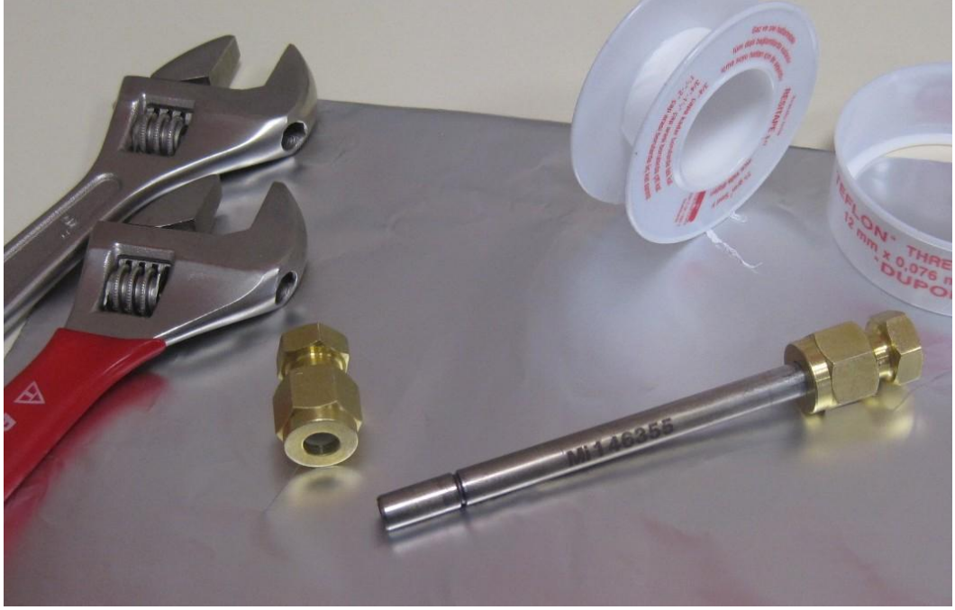
Şekil 2.12. Aktif örneklemede kullanılan tüplerin görünümü
