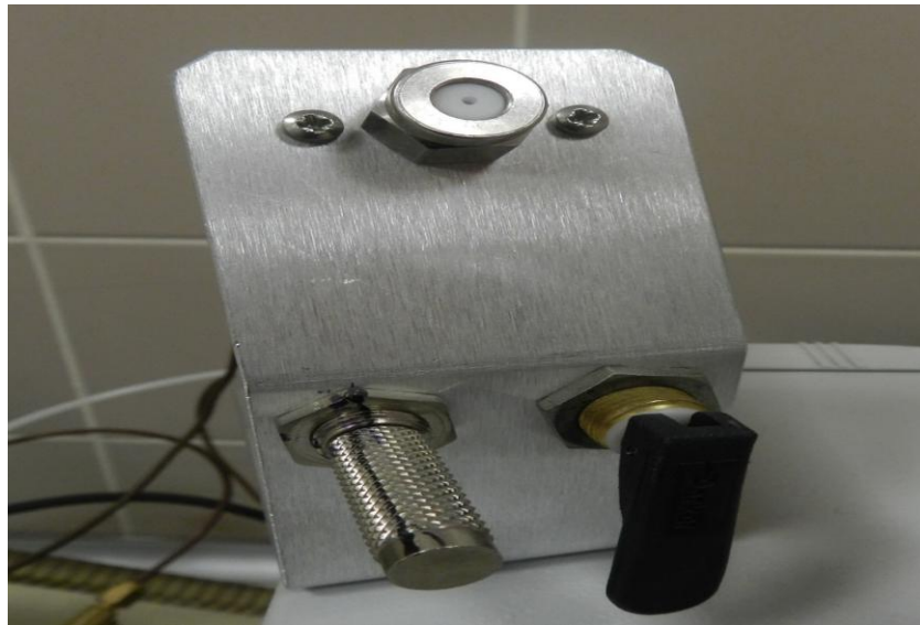
Şekil 2.23. Kalibrasyon tüpü için kullanılan enjeksiyon düzeneği
