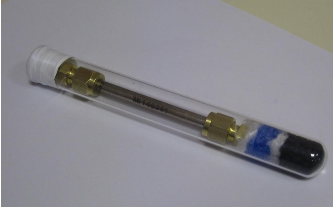
Şekil 2.13. Aktif örneklemede kullanılan tüplerin örnek alma sonrası görünümü
