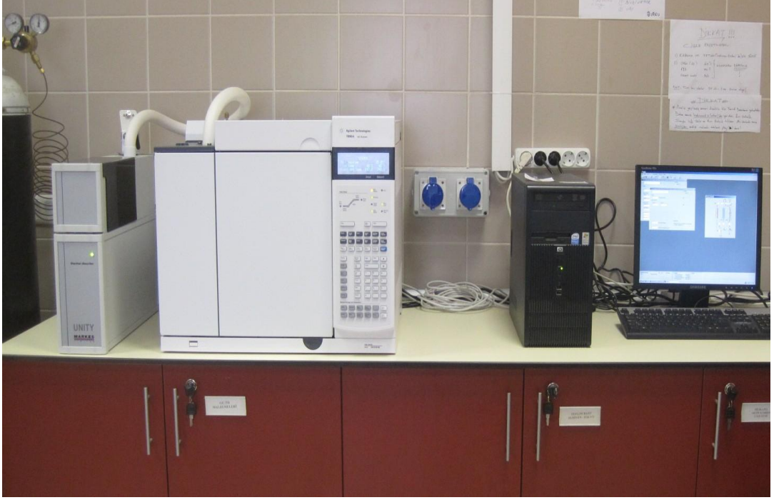
Şekil 2.22. TD-GC/FID çalışma düzeneği görünümü
