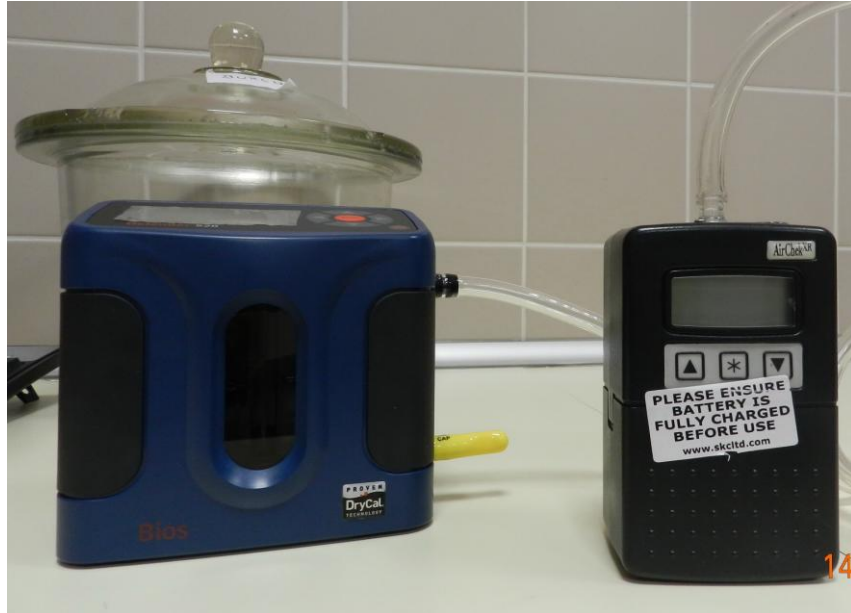
Şekil 2.17. Hava örnekleme pompası ve kalibratör cihazı
