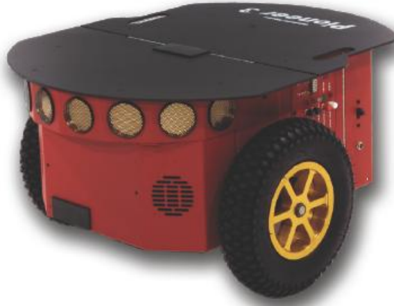
Şekil 4.1. Pioneer 3-DX gezgin robot
