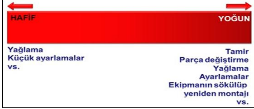
Şekil 1.3. Önleyici bakım seviyeleri
