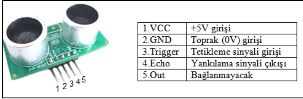
Şekil 2.14. DYP-ME007 ultrasonik entegre devresi ve pin bağlantıları
