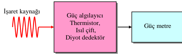
Şekil 1.1. Mikrodalga güç ölçüm sistemi blok şeması
