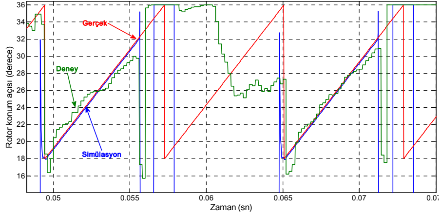
Şekil 4.20. Dişli=5, seviye=8, \omega=375 d/dk yükleme koşullarında açı tahmincisi deney ve simülasyon sonuçları ile gerçek konum açısının karşılaştırılması
