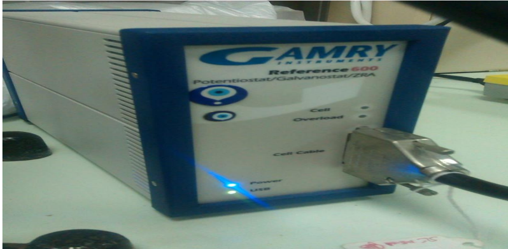
Şekil 2.1. Elektrokimyasal ölçümlerde kullanılan potansiyostat-galvanostat cihazı
