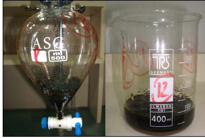
Şekil 5.28. NaOH katalizörü kullanıldığında gliserin tabakasının katılması
