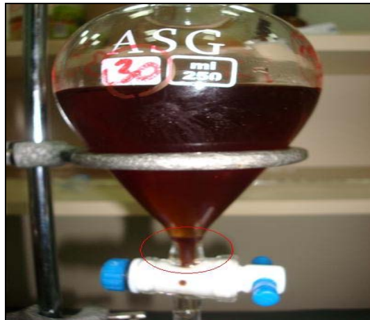
Şekil 5.23. %1 NaOMe katalizörü kullanılan transesterifikasyon reaksiyonu sonunda faz ayrışımı
