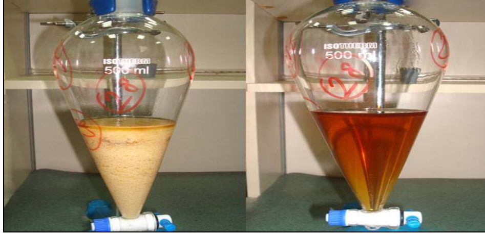
Şekil 5.22. KOMe ve NaOMe katalizörleri kullanılan transesterifikasyon reaksiyonu sonunda faz ayrışımının olmaması
