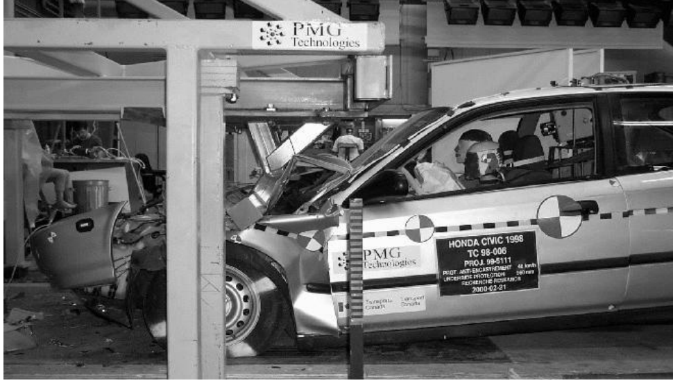
Şekil 4.17. Honda Civic, 560 mm SSG, 48 km/sa [30]
