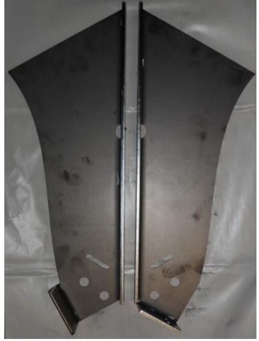
Şekil 5.6. NO 5 test numunesinin teknik çizimi ve lazer kesimi sonrası büküm hali
