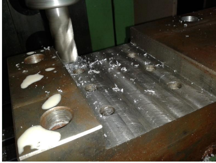
Şekil 5.13. İki parçayı birbirine bağlamak için açılan kanal
