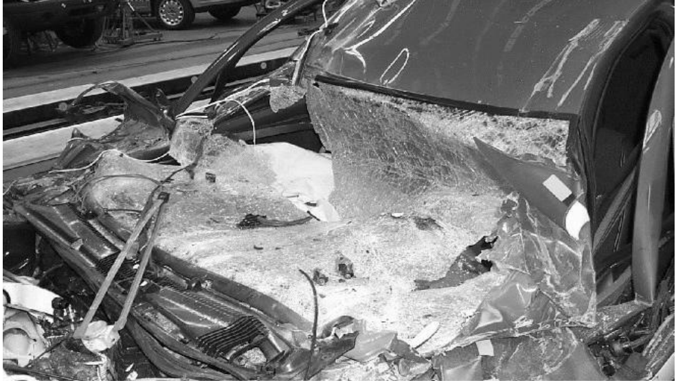
Şekil 4.13. Direklerde meydana gelen hasarın detayları, 480 mm MCG, 65 km/sa hız, Chevrolet Cavalier [30]
