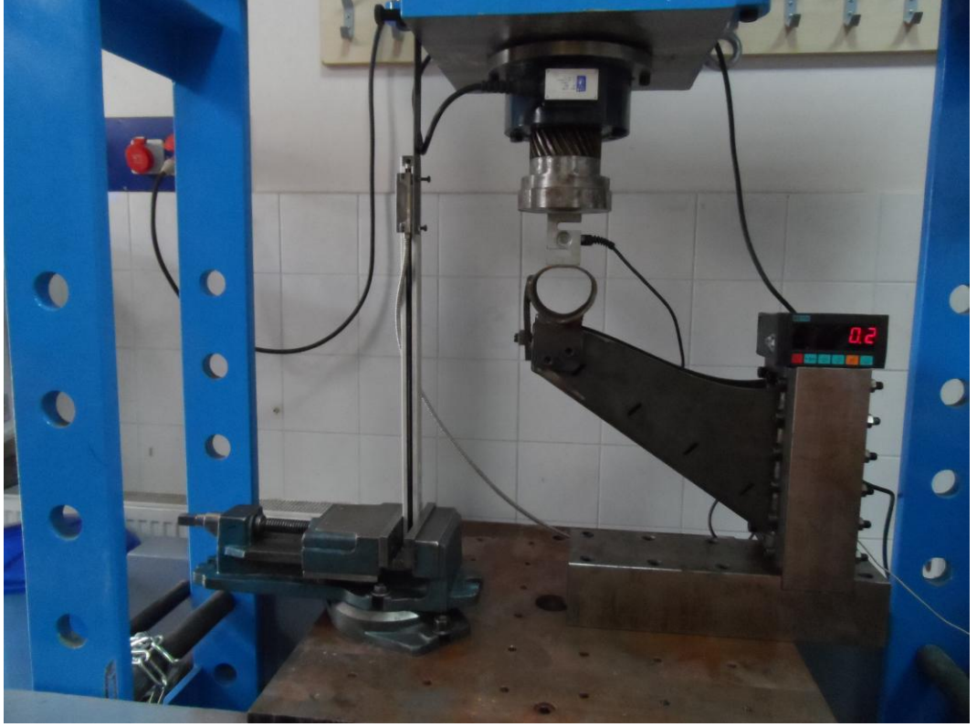
Şekil 5.18. Yarı statik yükleme ünitesinde yük hücresi ve test numunesinin yerleştirilmesi
