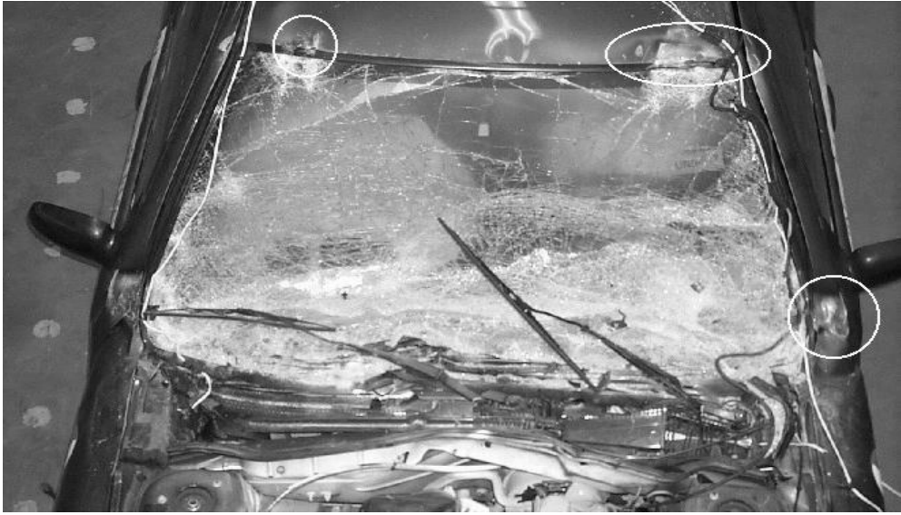
Şekil 4.10. 560 mm yükseklikte MCG tipi koruyucu, 48 km/sa hızda, test sonrası dış hasar [30]
