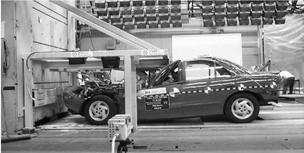
Şekil 4.12. 480 mm MCG, 65 km/sa hız, Chevrolet Cavalier [30]
