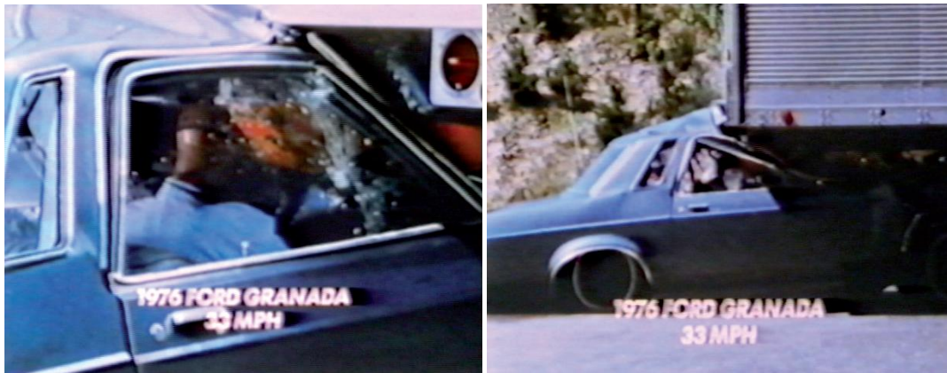
Şekil 2.3. 1976 model Ford Granada marka aracın 54 km/h hızla çarpışma testi [12]
