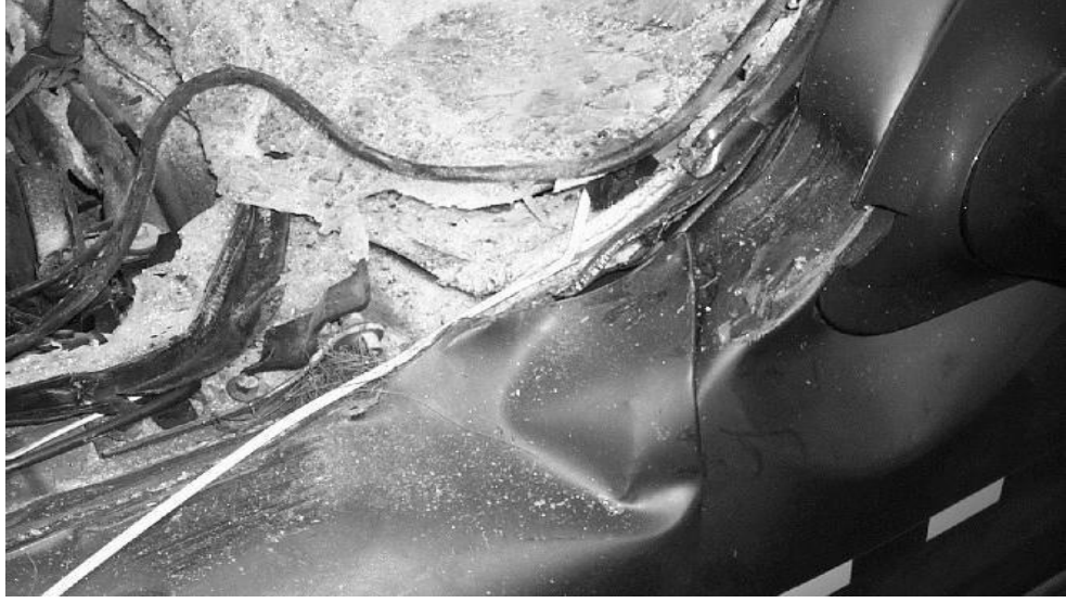
Şekil 4.11. 560 mm yükseklikte MCG tipi koruyucu, 48 km/sa hızda, test sonrası ön cam direğindeki hasar [30]
