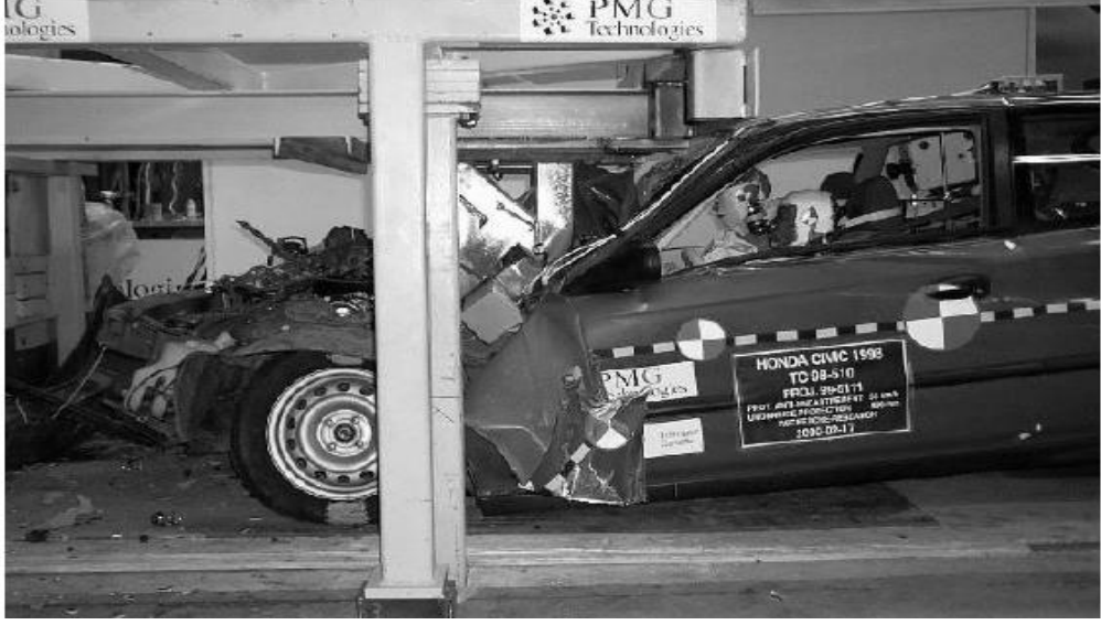
Şekil 4.16. Honda Civic, 480 mm DLG, 56 km/sa [30]
