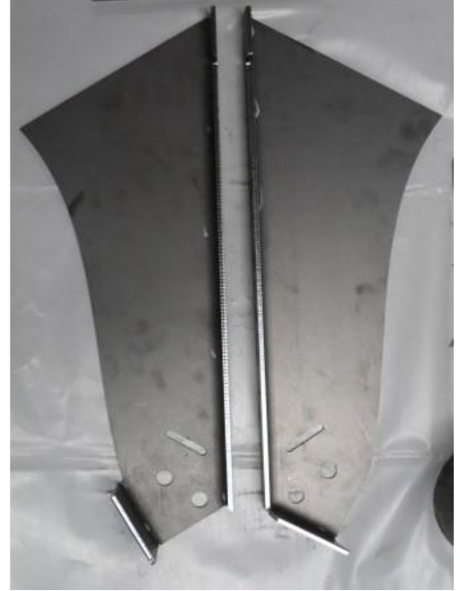
Şekil 5.7. NO 6 test numunesinin teknik çizimi ve lazer kesimi sonrası büküm hali
